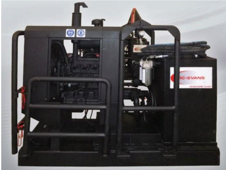
Slika 2.3. Stacionarna pogonska jedinica u obliku hidroagregata [3]
