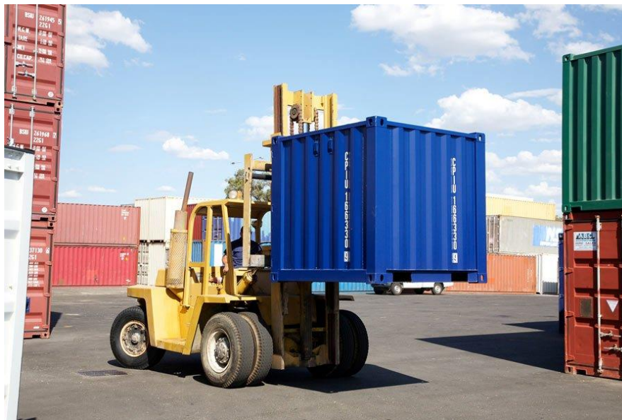
Slika 3.47. Podizanje kontejnera viličarom [24]
