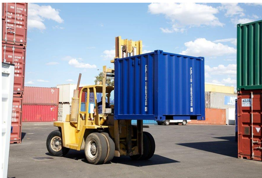
Slika 3.47. Podizanje kontejnera viličarom [24]
