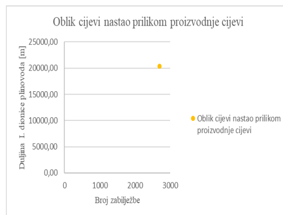
Slika 19. Broj zabilježbi oblika cijevi nastalih prilikom proizvodnje cijevi po duljini I. dionice plinovoda [m]
