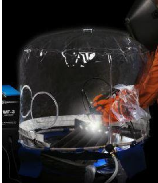
Slika 22: Izvođenje postupka zavarivanja u komori za zavarivanje [29]
