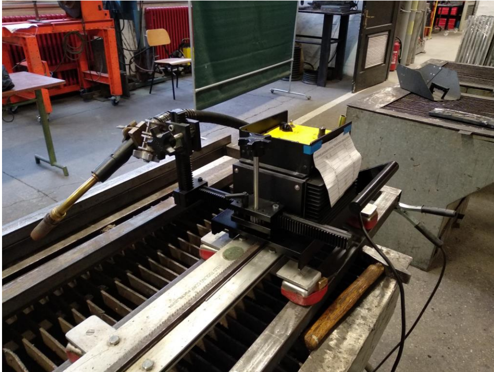
Slika 25: „BUGO Systems" sustav za mehanizaciju postupka zavarivanja
