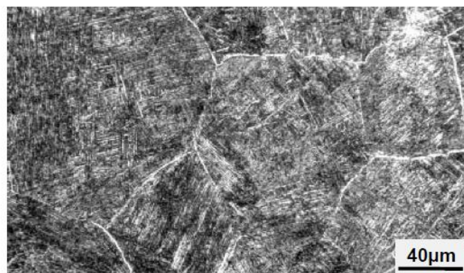
Slika 8: Lamelarna mikrostruktura u zoni utjecaja topline pod većim uvećanjem [9]
