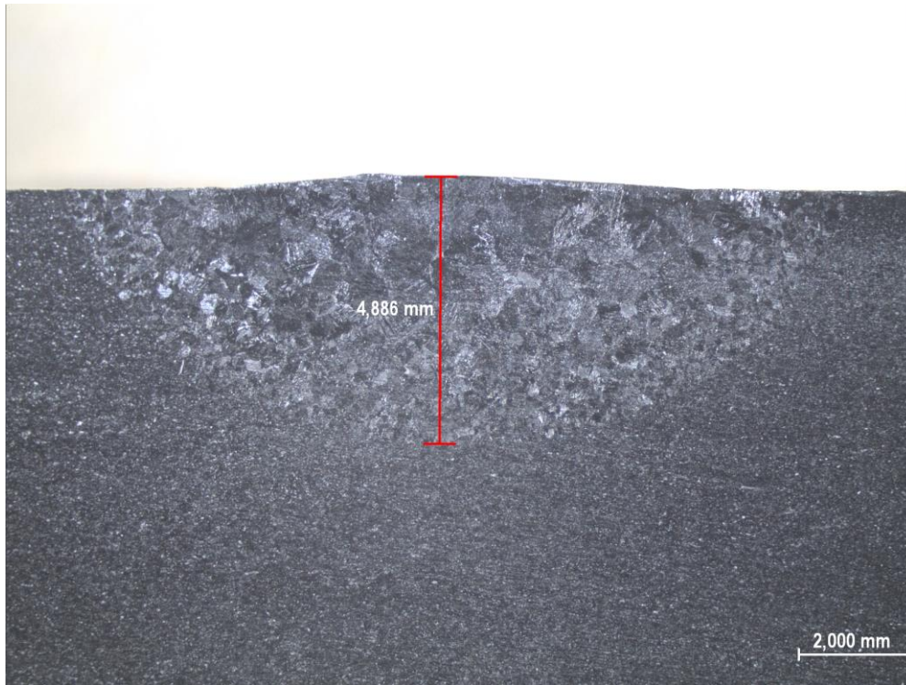
Slika 31: Profil navara i izmjerena dubina penetracije na uzorku A1
