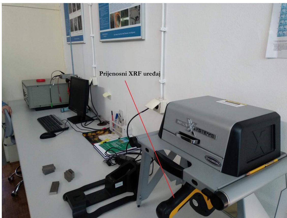
Slika 23: Sustav za XRF analizu kemijskog sastava materijala
