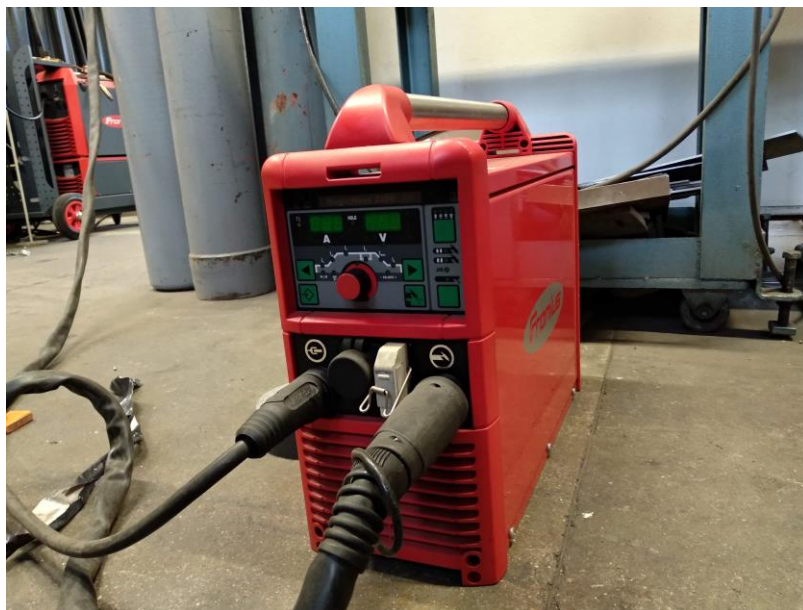
Slika 24: Fronius MagicWave 2200 Job G/F korišten u eksperimentu
