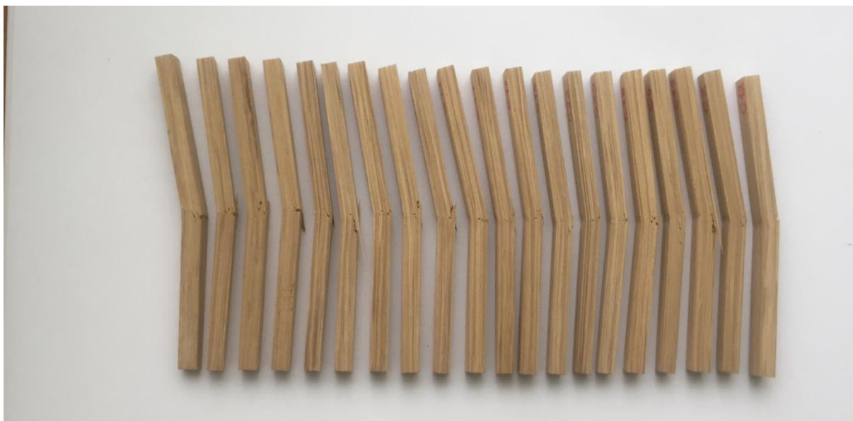
Slika 31. Uzorci hrasta lužnjaka nakon ispitivanja na kidalici
