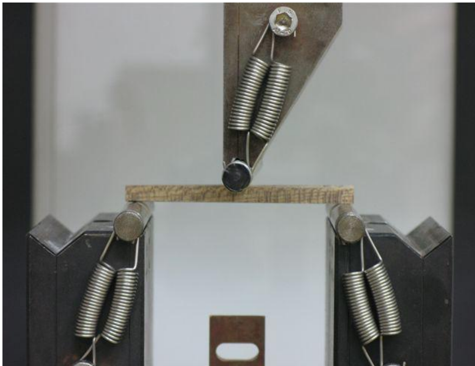
Slika 28. Ispitni uzorak na kidalici neposredno prije opterećivanja
