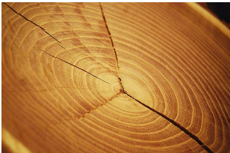
Slika 6. Godovi hrasta lužnjaka u poprečnom presjeku debla [6]
