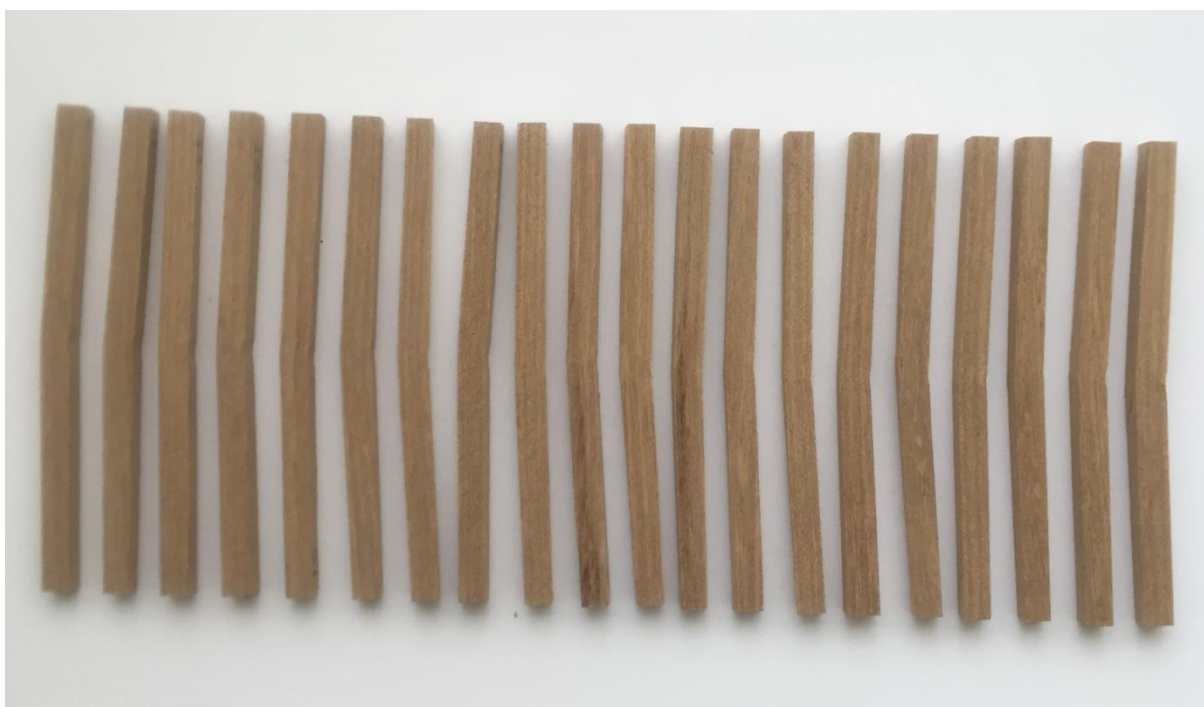
Slika 30. Uzorci brijesta nakon ispitivanja
