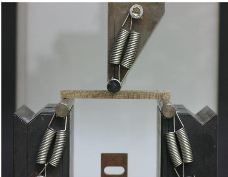
Slika 28. Ispitni uzorak na kidalici neposredno prije opterećivanja
