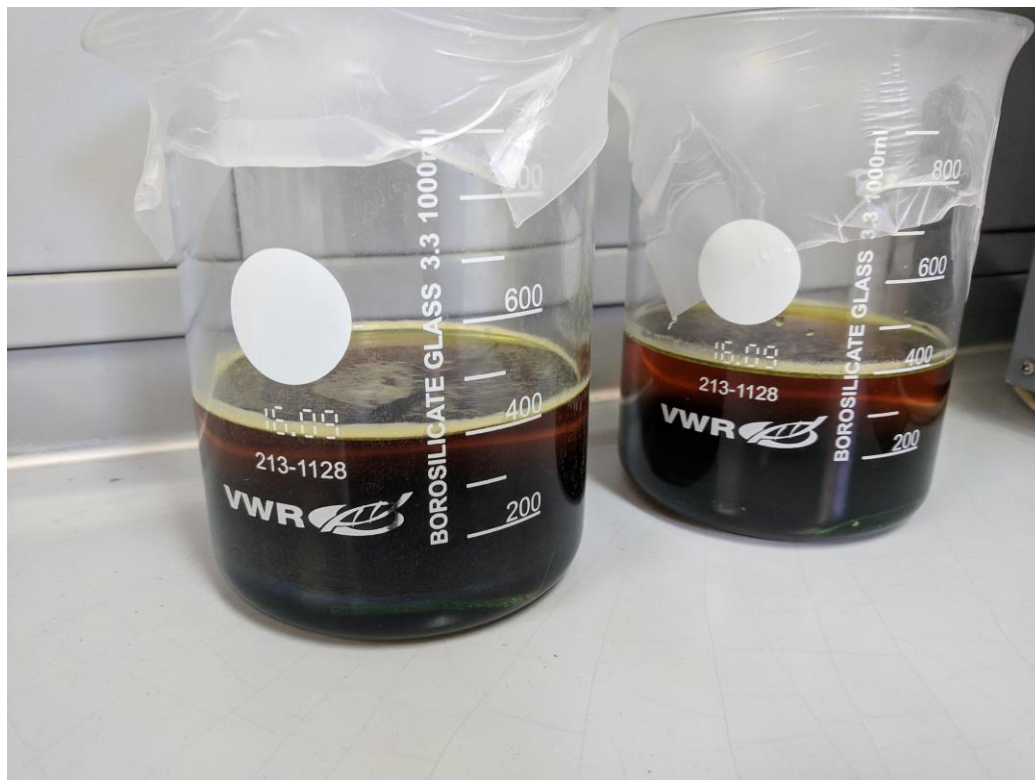
Slika 64. Prikaz uzoraka u agresivnoj otopini neposredno prije vađenja
