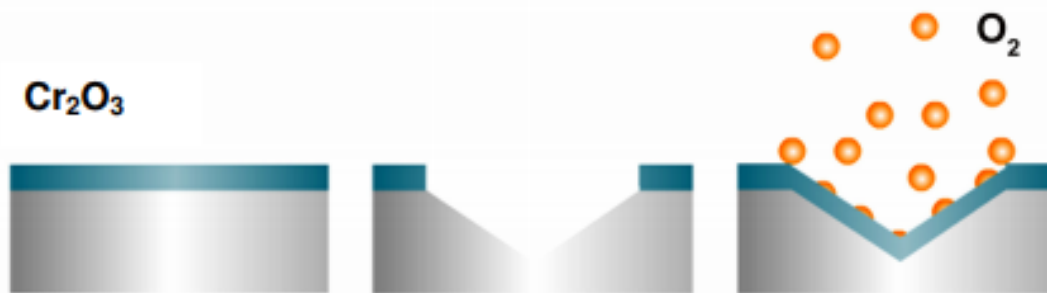
Slika 3. Mehanizam samoobnavljanja pasivnog filma [2]
