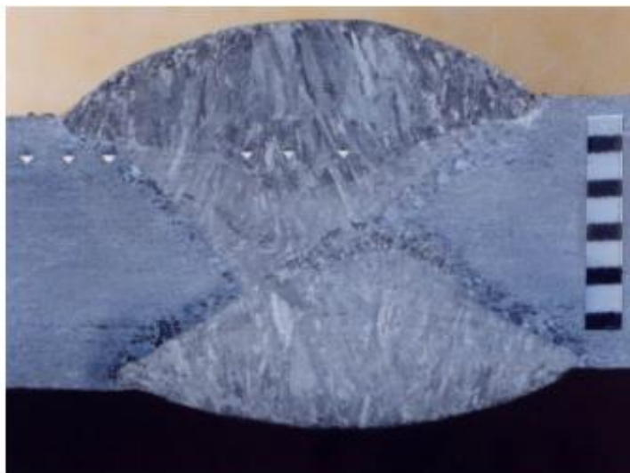
Slika 5. Prikaz karakterističnih problema kod zavarivanja feritnih nehrđajućih čelika
