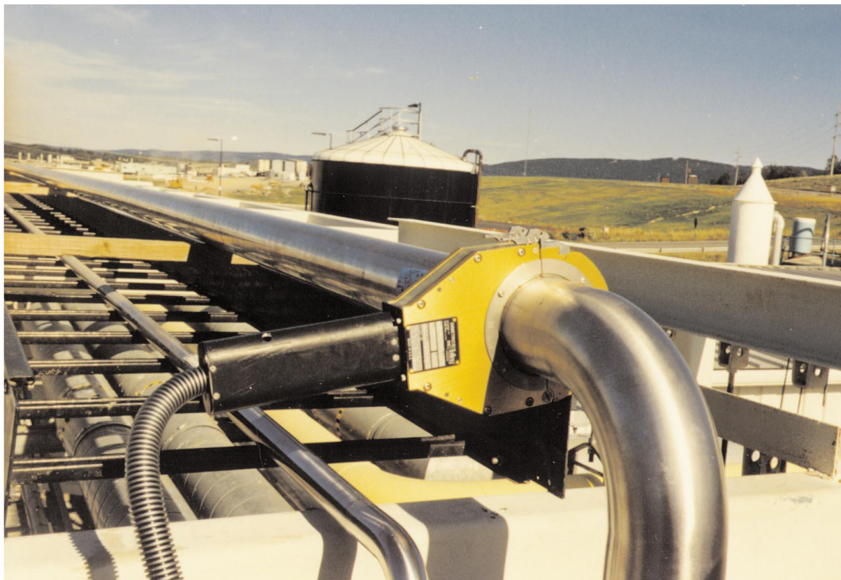
Slika 30. Primjer zatvorene glave za zavarivanje [42]
