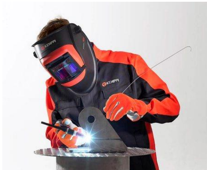
Slika 12. Ručno TIG zavarivanje [13]
