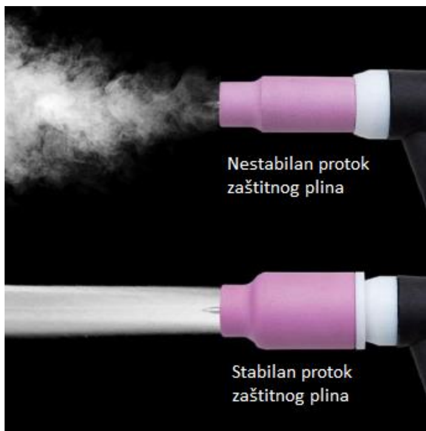
Slika 21. Stabilan i nestabilan protok zaštitnog plina [13]
