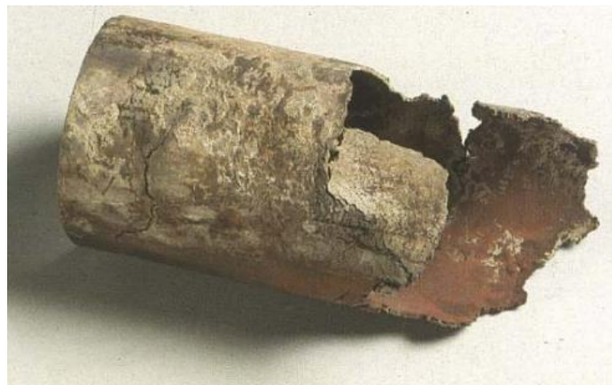
Slika 23. Primjer napetosne korozije nehrđajućeg čelika AISI 316[25]
