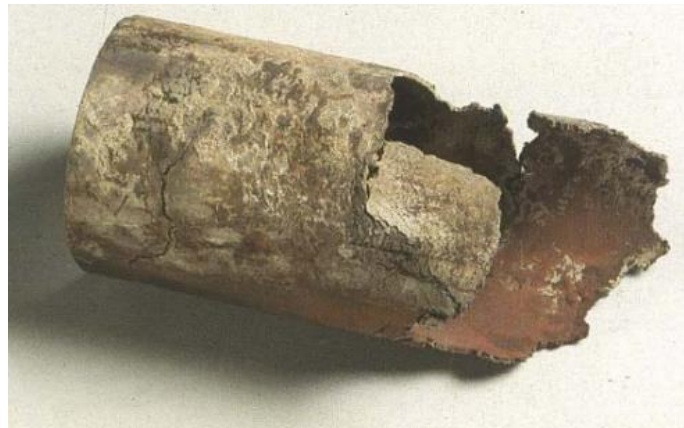
Slika 23. Primjer napetosne korozije nehrđajućeg čelika AISI 316[25]
