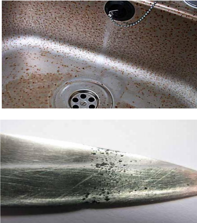
Slika 13. Primjeri djelovanja rupičaste korozije na razne vrste čelika [17]
