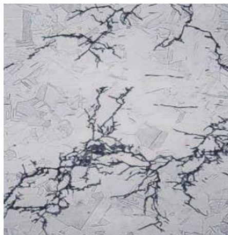
Slika 24. Transkristalna napetosna korozija AISI 316 čelika[25]
