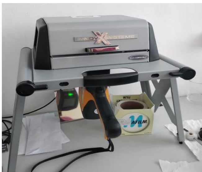
Slika 38. Uređaj XRF- Olympus
