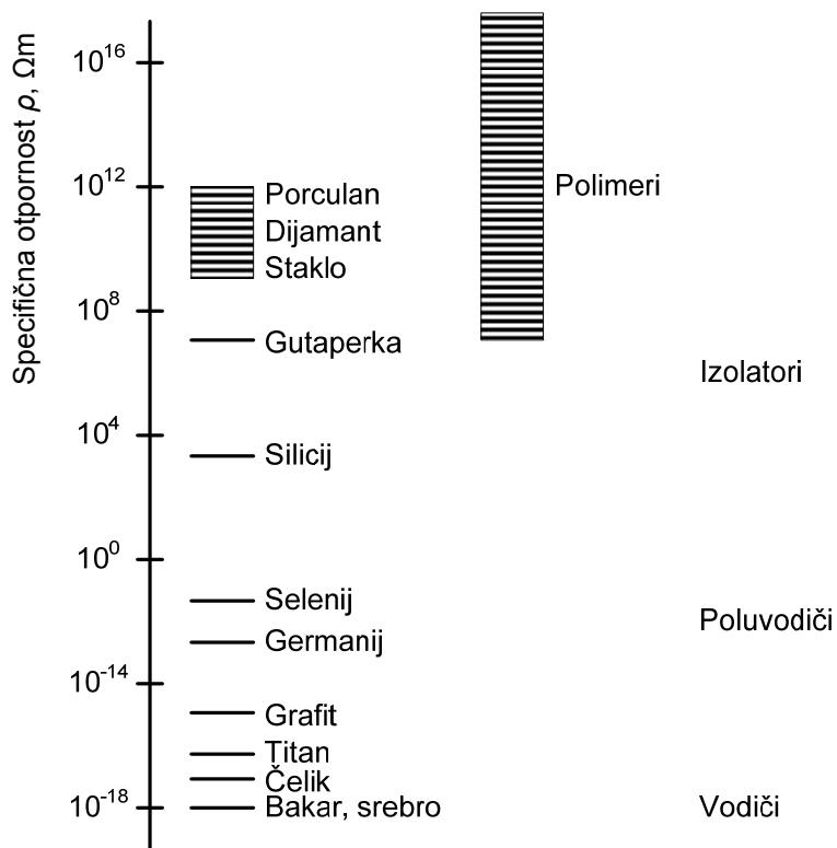
Slika 2.18. Specifična otpornost inženjerskih električnih materijala [1]
