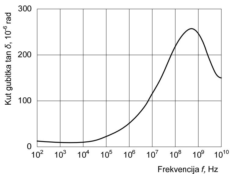
**Slika 2.7. Ovisnost faktora rasipanja o frekvenciji za PTFE [1]**
