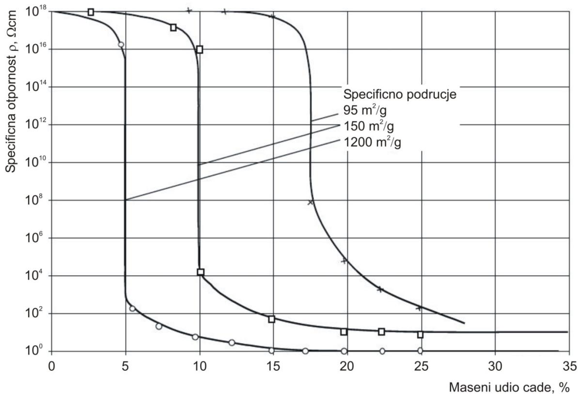
Slika 2.24. Specifična otpornost polipropilena ispunjenog čadom [2]
