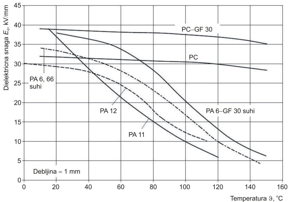
Slika 2.32. Dielektrična snaga odabralih polimernih materijala u ovisnosti o temperaturi [2]
