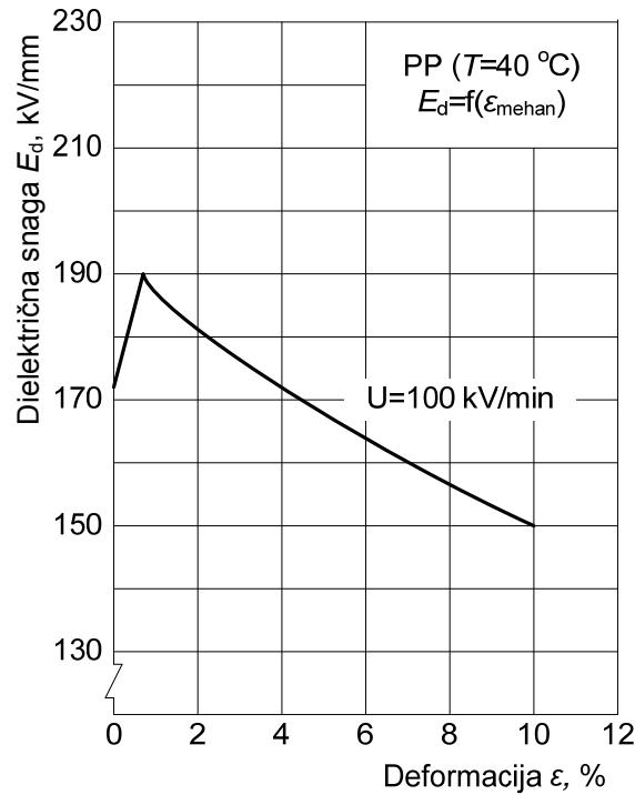
Slika 2.37. Opadanje dielektrične snage PP filmova s povećanjem deformacije [2]
