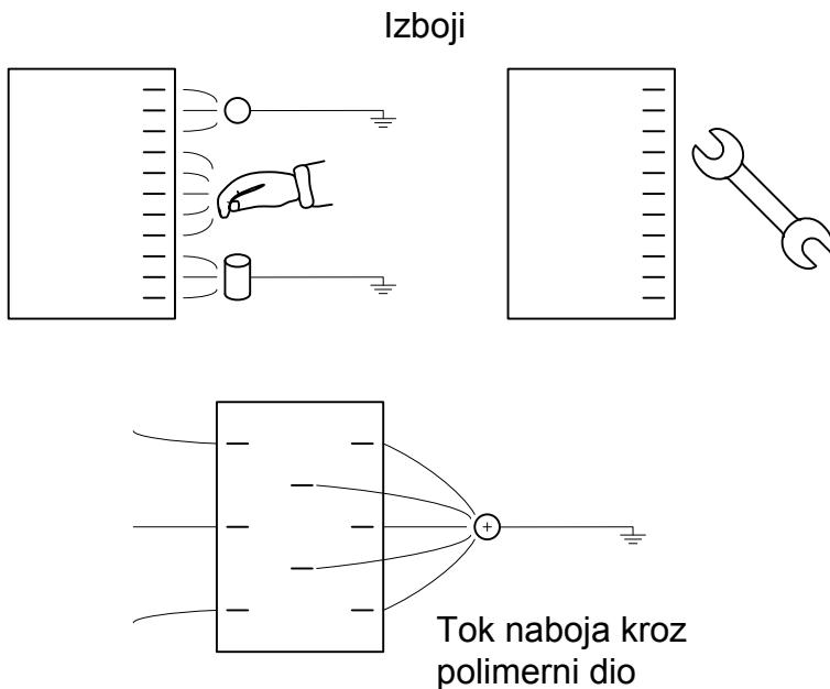
Slika 2.39. Elektrostatski naboji u polimernim materijalima [2]
