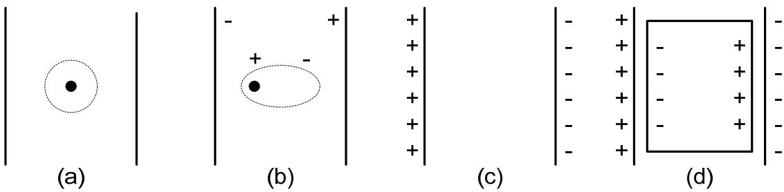
**Slika 2.11.** (a) Atom bez utjecaja vanjskog električnog polja (b) Elektronski oblak pomaknut pod djelovanjem vanjskog električnog polja (c) Nabijene kondenzatorske ploče odvojene podtlakom (d) Kondenzatorske ploče odvojene dielektrikom [3]
