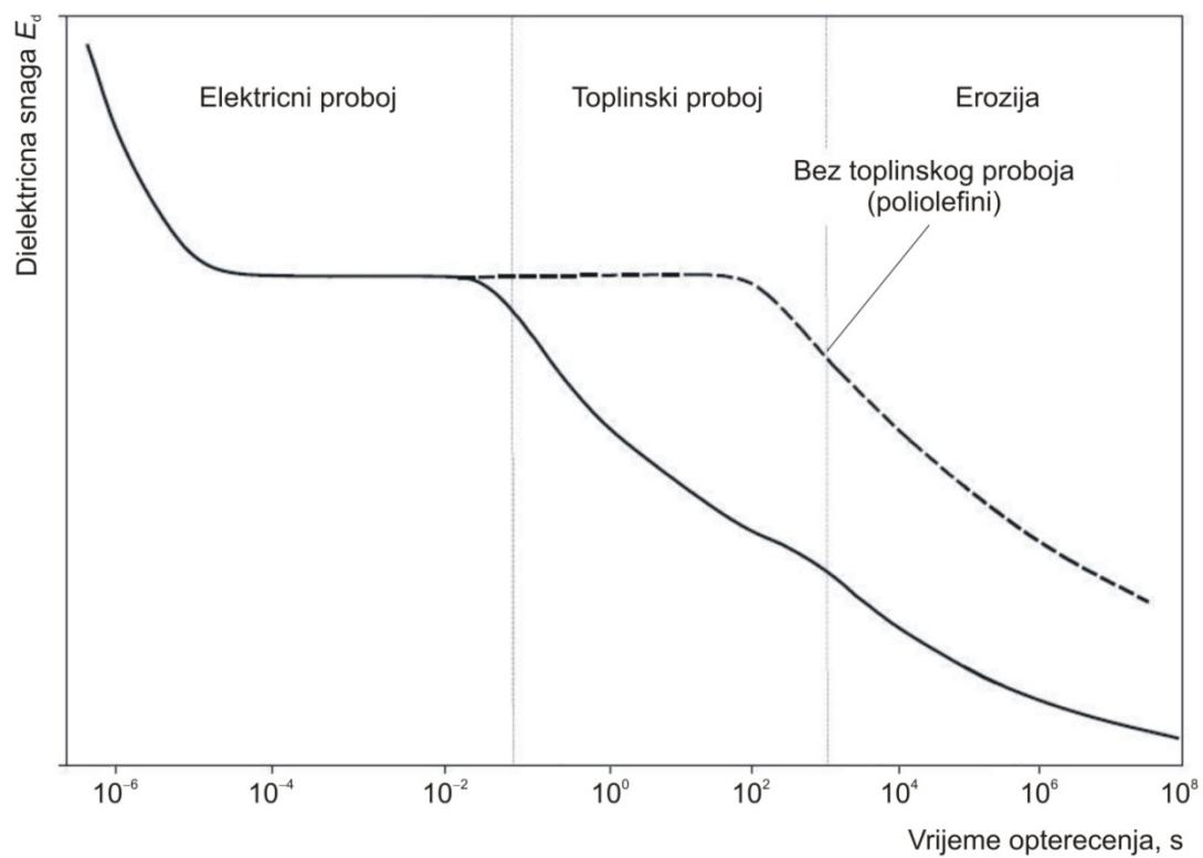
**Slika 2.30. Tijek opadanja dielektrične snage s vremenom [2]**
