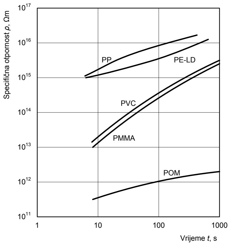
Slika 2.19. Promjene specifične otpornosti s vremenom nekih polimera [1]
