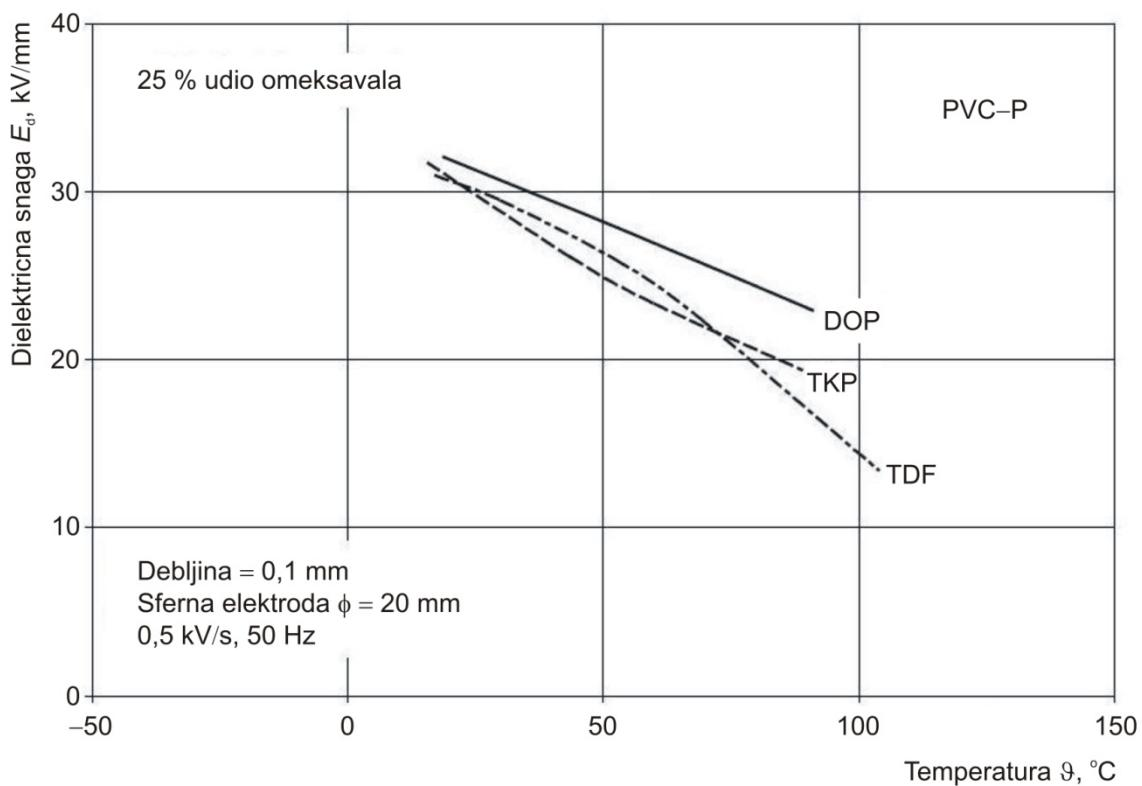
Slika 2.35. Dielektrična snaga za omešani PVC, s udjelom različitih omešavala od 25 %, u ovisnosti o temperaturi [2]
