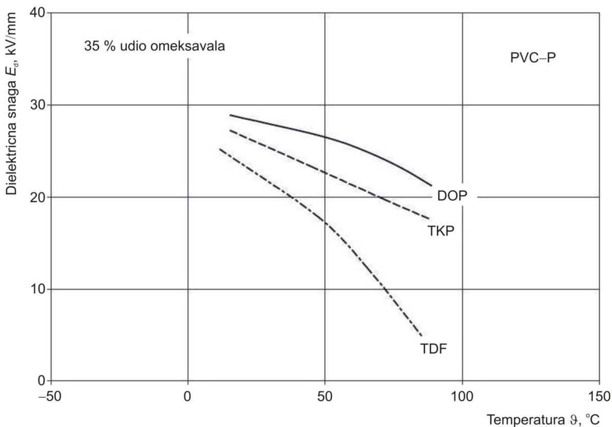
**Slika 2.36. Dielektrična snaga za omešani PVC, s udjelom različitih omešavala od 35 %, u ovisnosti o temperaturi [2]**
