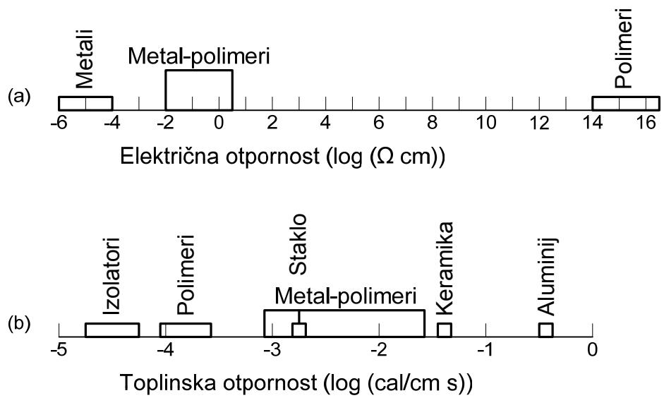
**Slika 2.40. Usporedba vodljivih polimera s ostalim materijalima:** (a) Usporedba električne otpornosti metal-polimera s otpornosti metalova i polimera (b) Usporedba toplinske otpornosti metal-polimera s ostalim materijalima [2]
