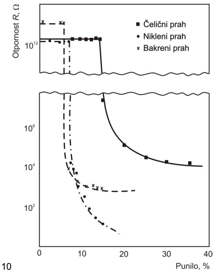
**Slika 2.23. Otpornost epoksidne smole ispunjene metalnim prahovima [2]**
