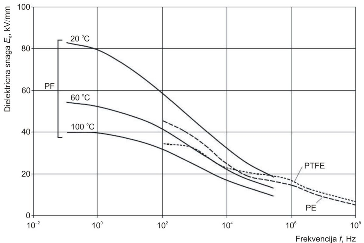
Slika 2.33. Dielektrična snaga odabralih polimera u ovisnosti o temperaturi [2]
