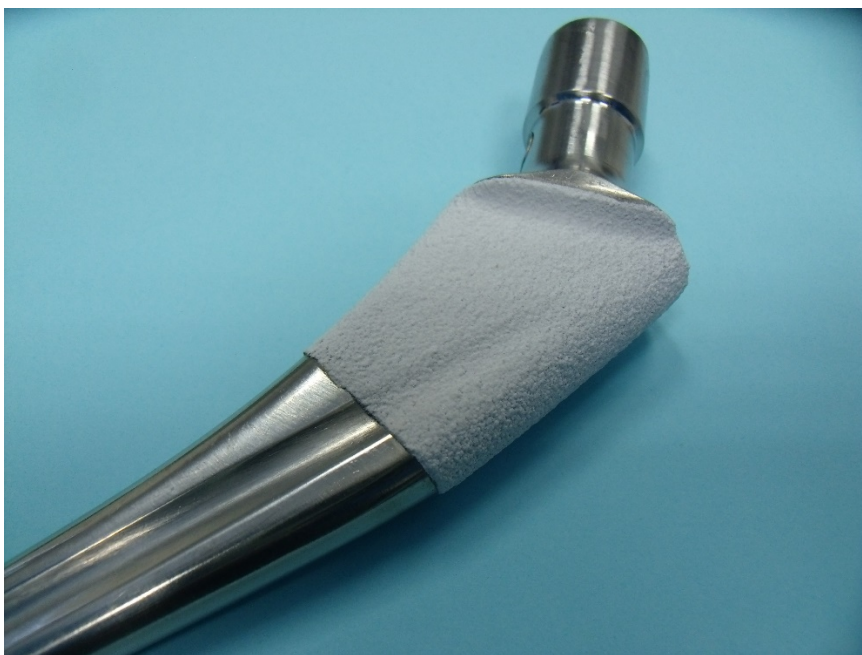
Slika 10. Prevlaka od hidroksiapatita na femuralnom dijelu implantatata zgloba kuka [23]
