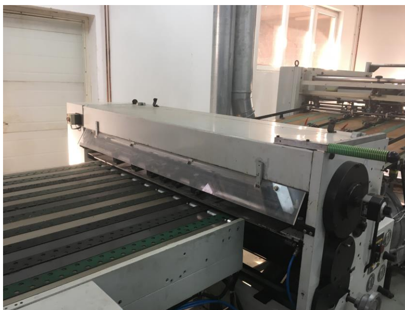
Slika 21. Dio stroja za uklanjanje pudera papira
