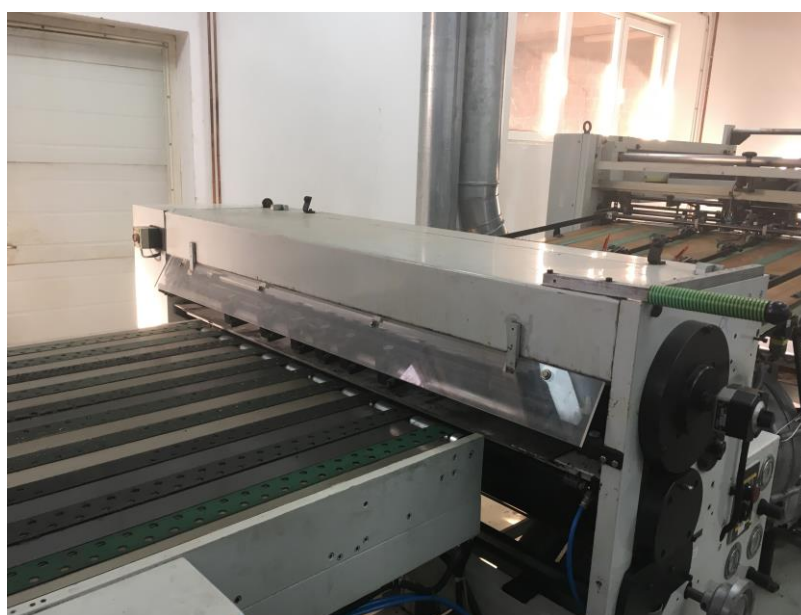
Slika 21. Dio stroja za uklanjanje pudera papira
