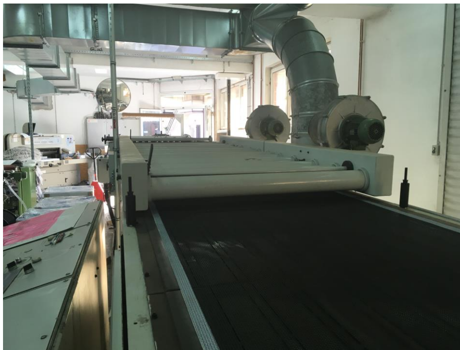
Slika 24. Dio stroja s fenovima za vrući zrak
