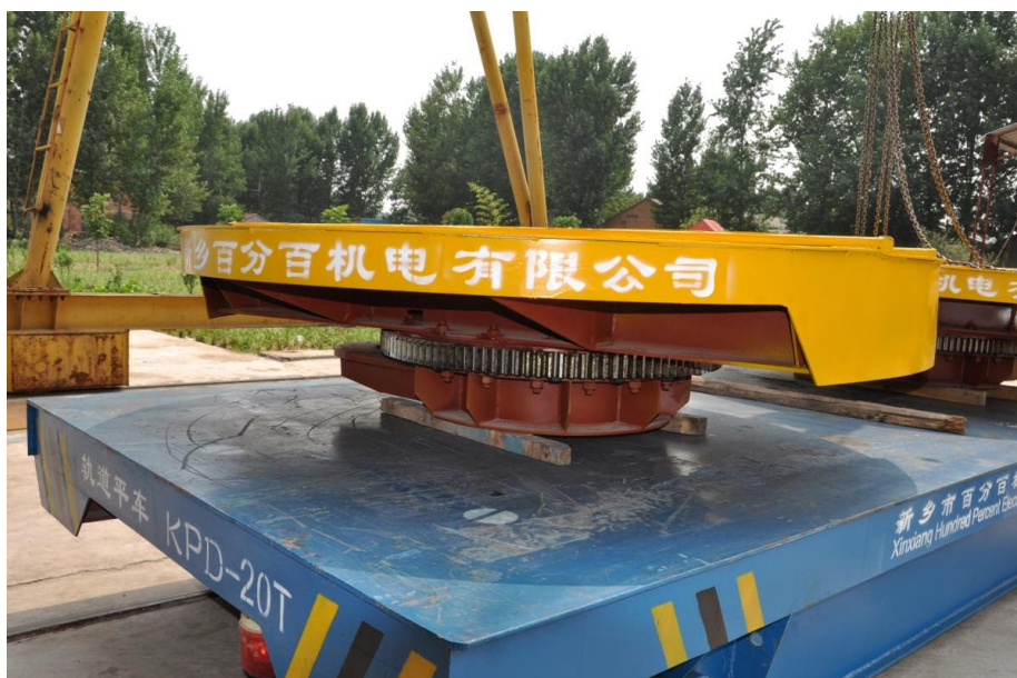
Slika 1.5: Rotacijska platforma sa okretnim ležajem izvedenim sa vanjskim ozubljenjem [1]
