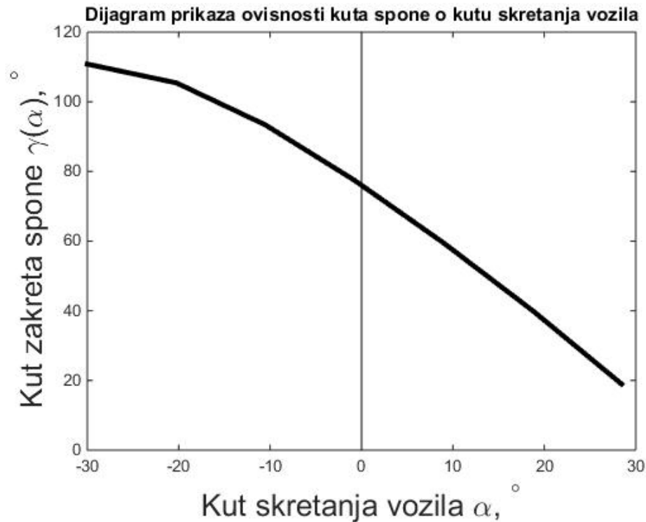
Slika 4.2: Prikaz ovisnosti promjene kuta spone i kuta skretanja
