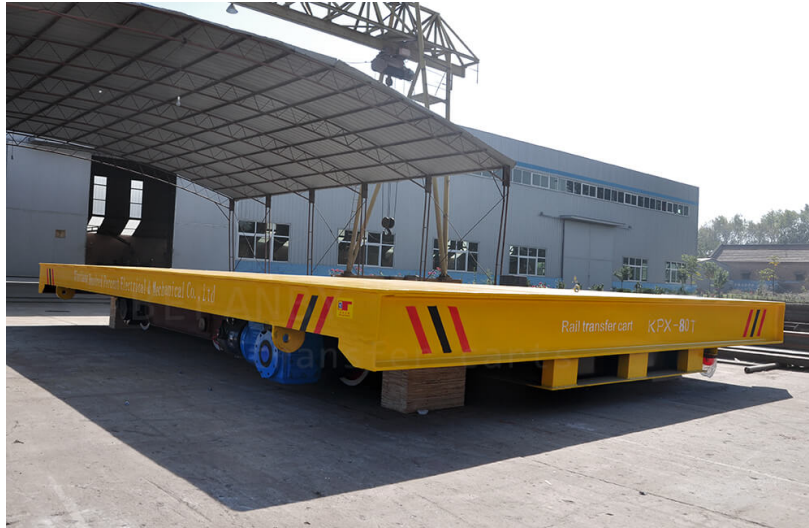
Slika 1.4: Kolica sa vlastitim izvorom energije (baterija) prema [1]
