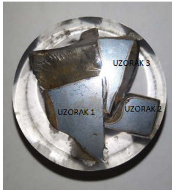
Slika 23. Uzorci uliveni u polimernu masu
