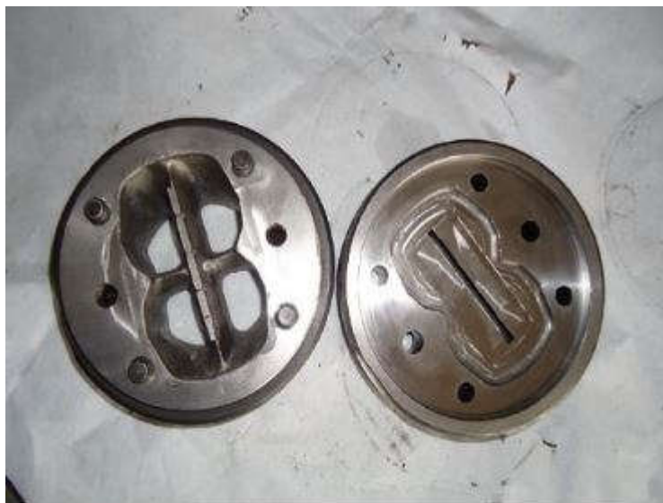
Slika 4. Alat za provlačenje aluminija [3]
