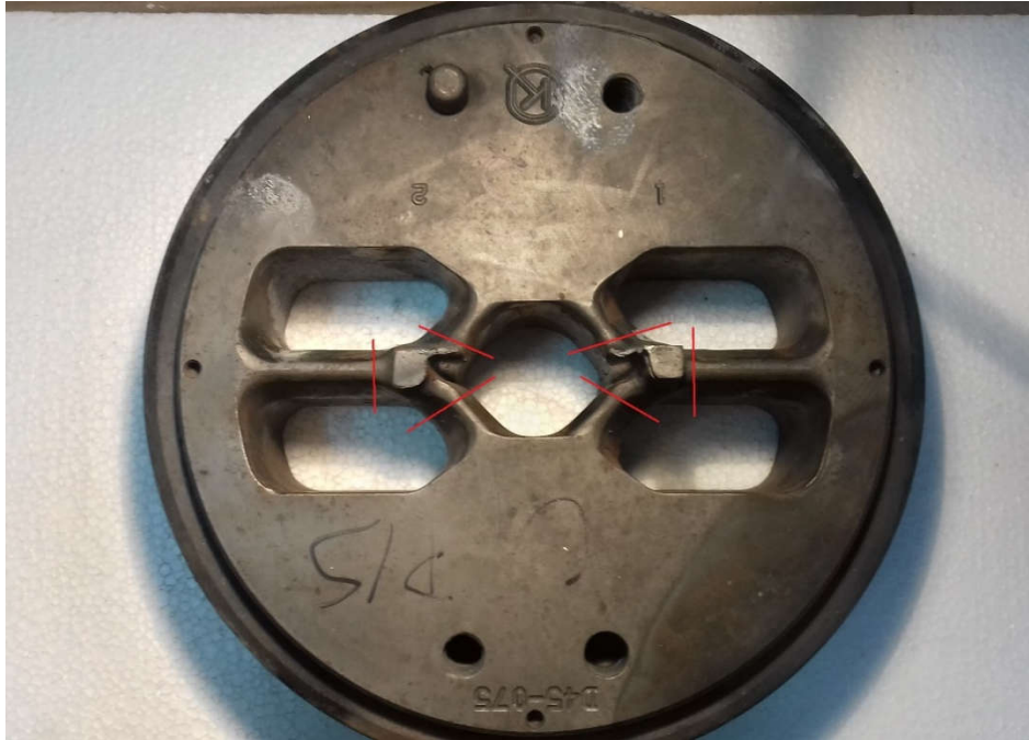
Slika 19. Mjesta izrezivanja uzorka
