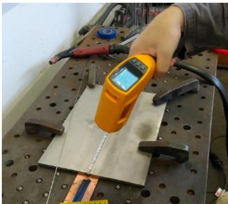
Slika 24. Mjerenje međuprolazne temperature
