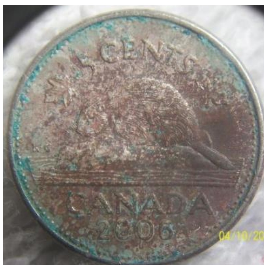
Slika 2. Pojava zelenkastog sloja patine na kovanici izrađenoj od nikla [5]
