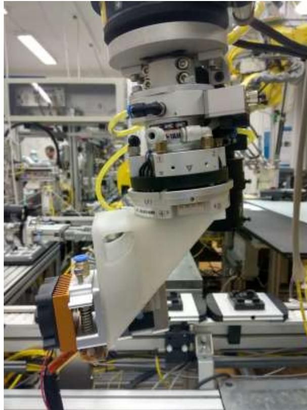
**Slika 7. Ekstruder montiran na robotsku ruku**
