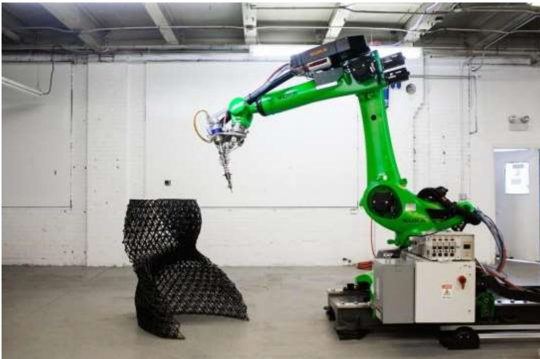
Slika 3. Robotsko 3D tiskanje [8]
