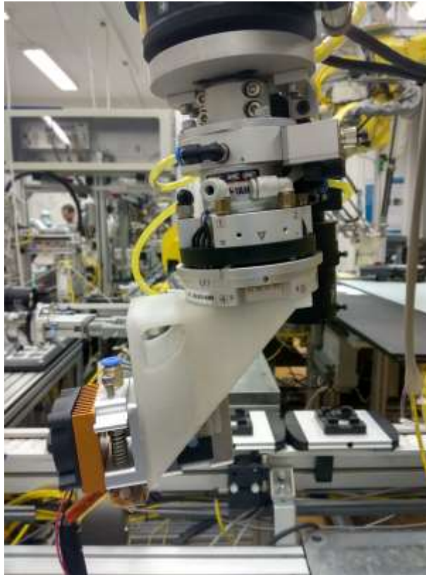
Slika 7. Ekstruder montiran na robotsku ruku
