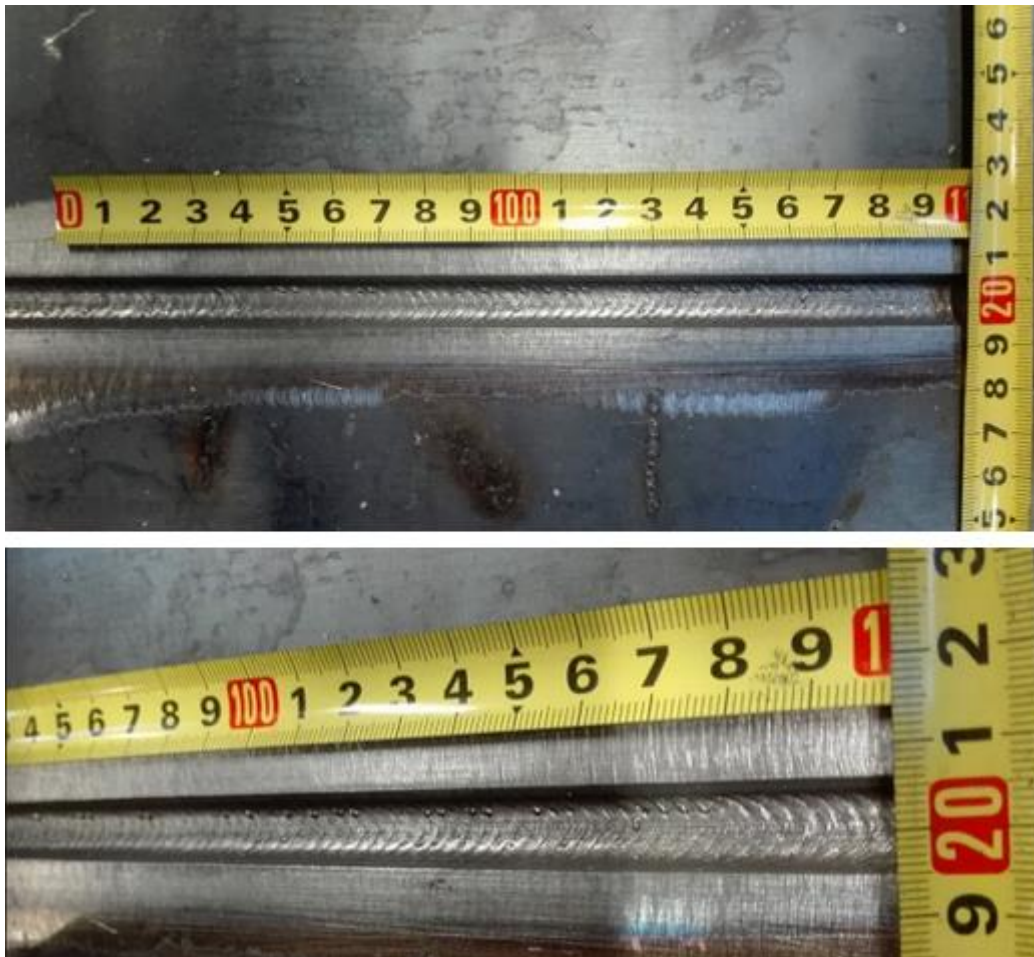
Slika 62. Izgled zavarenog spoja korijena
