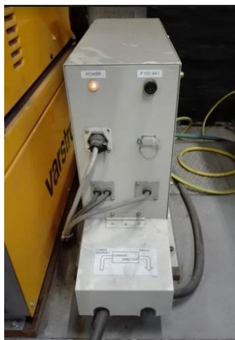
Slika 52. Senzor električnog luka AX - AR
