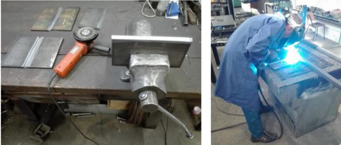
Slika 56. Postupak brušenja (lijevo) i pripajanja (desno) uzorka
