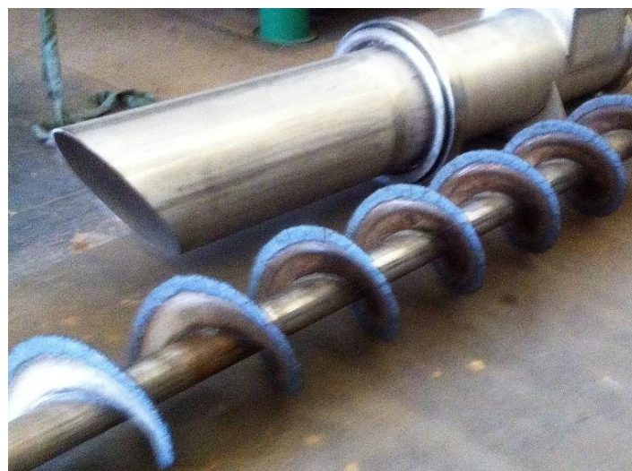
Slika 40. Vreteno vijčane pumpe [43]
