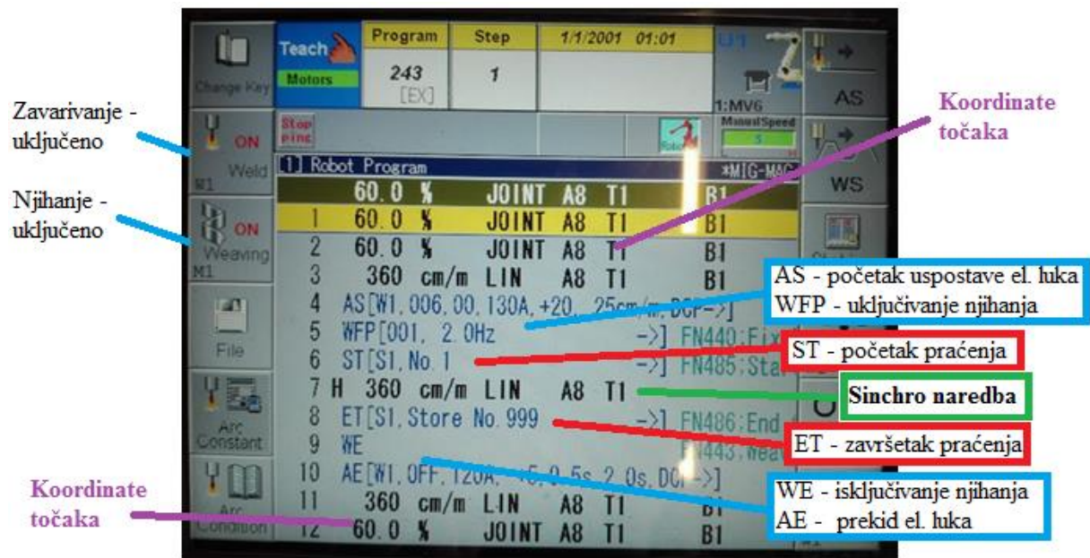
Slika 71. Prikaz programa za praćenje zavarenog spoja
