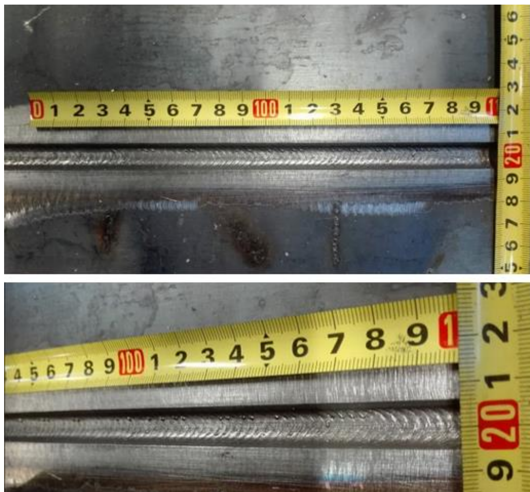
Slika 62. Izgled zavarenog spoja korijena
