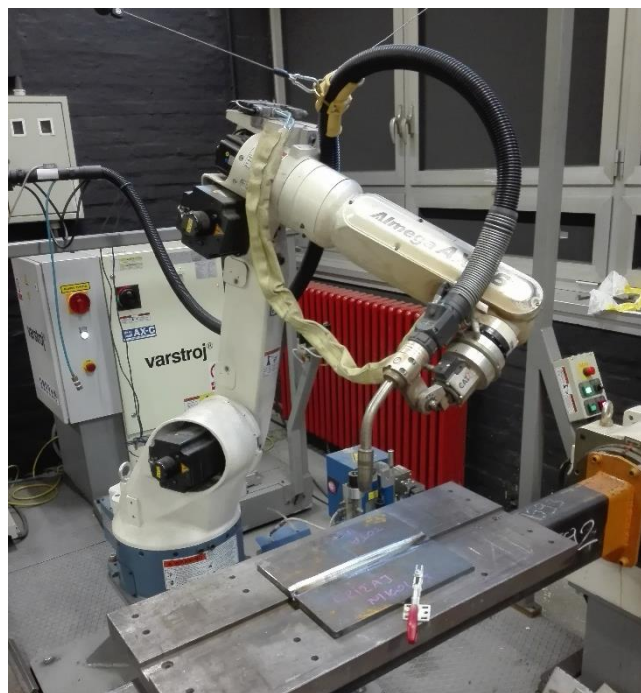
Slika 44. Robot AX - V6 u položaju za zavarivanje
