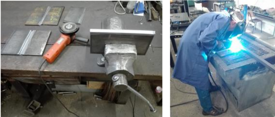
Slika 56. Postupak brušenja (lijevo) i pripajanja (desno) uzorka
