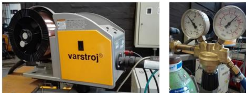
Slika 59. Automatska dobava žice EZ - SG 2 i podešavanje protoka zaštitnog plina M21
