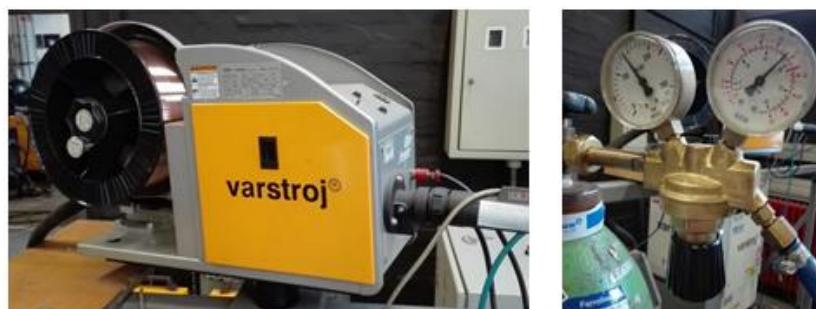
Slika 59. Automatska dobava žice EZ - SG 2 i podešavanje protoka zaštitnog plina M21
