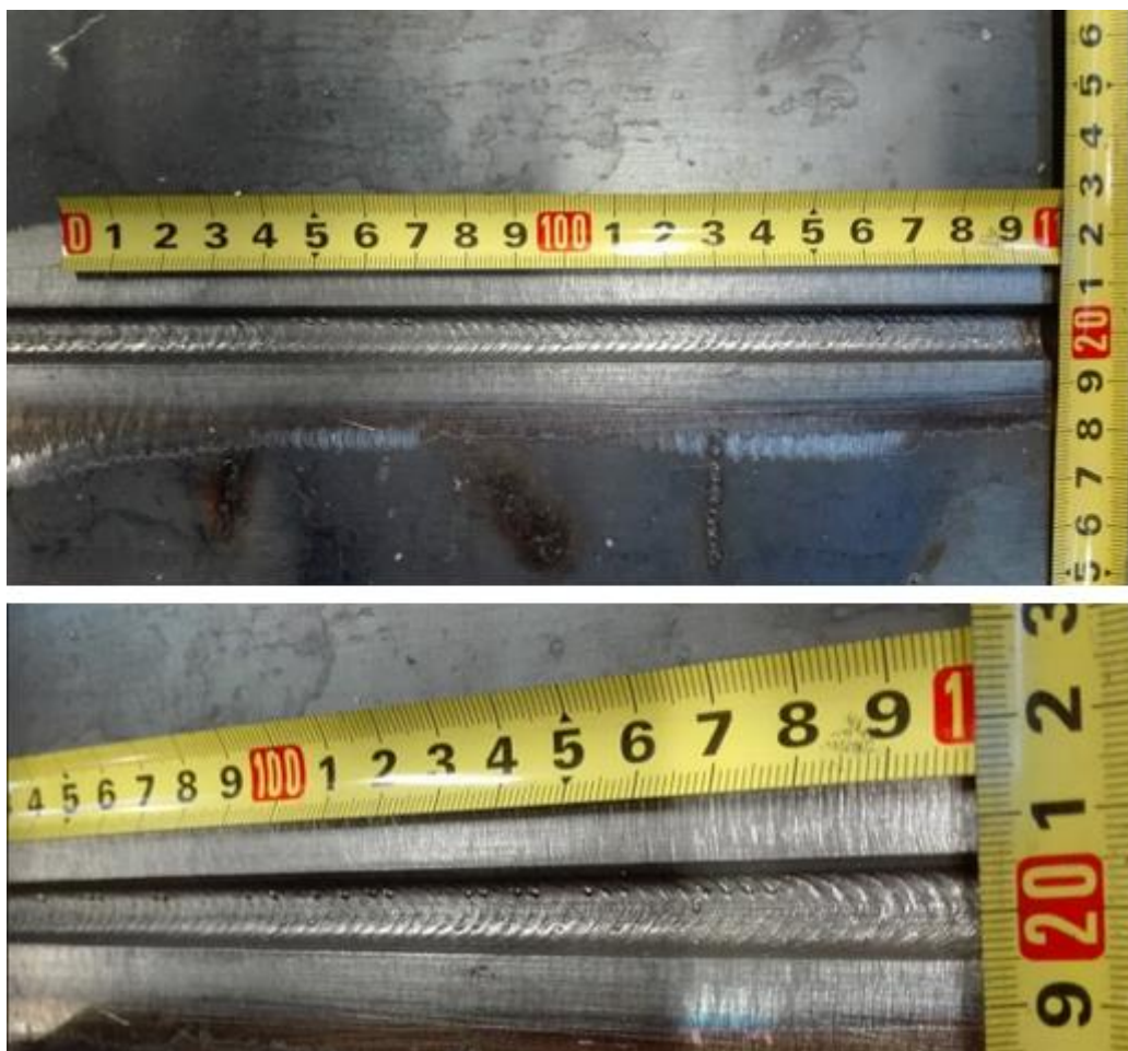
Slika 62. Izgled zavarenog spoja korijena
