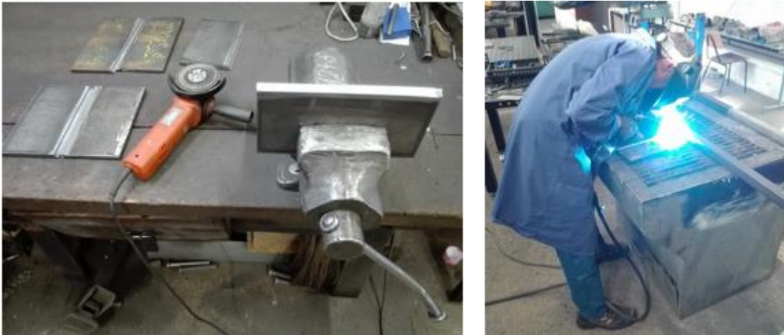
Slika 56. Postupak brušenja (lijevo) i pripajanja (desno) uzorka
