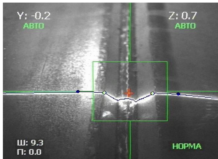
Slika 39. Određivanje geometrije primjenom video kamere [42]
