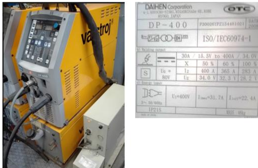
Slika 50. Izvor struje OTC Daihen 400 i njegove specifikacije
