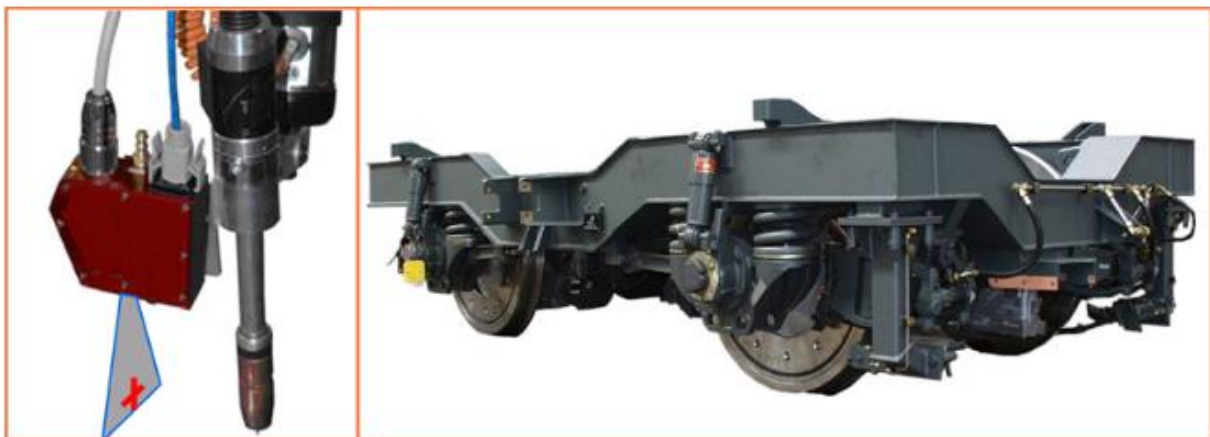
Slika 38. Kolica putničkog vagona proizvedena upotrebom laserskog senzora [41]
