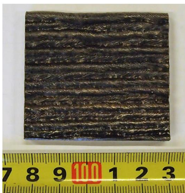
Slika 37. Uzorak zida nakon odvajanja od podloge i uklanjanja jednog kraja.
