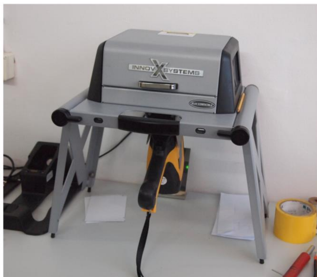
Slika 43. XRF – analizator za laboratorijska ispitivanja Innov-X Systems.
