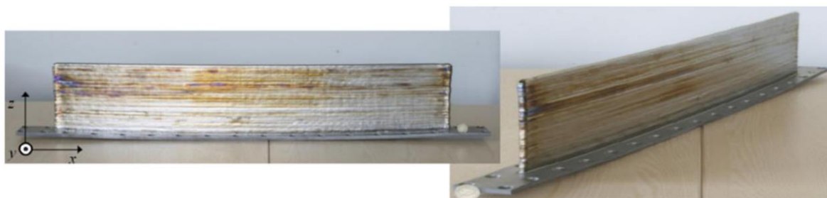
Slika 20. Primjer zida izrađenog WAAM tehnologijom [28].
