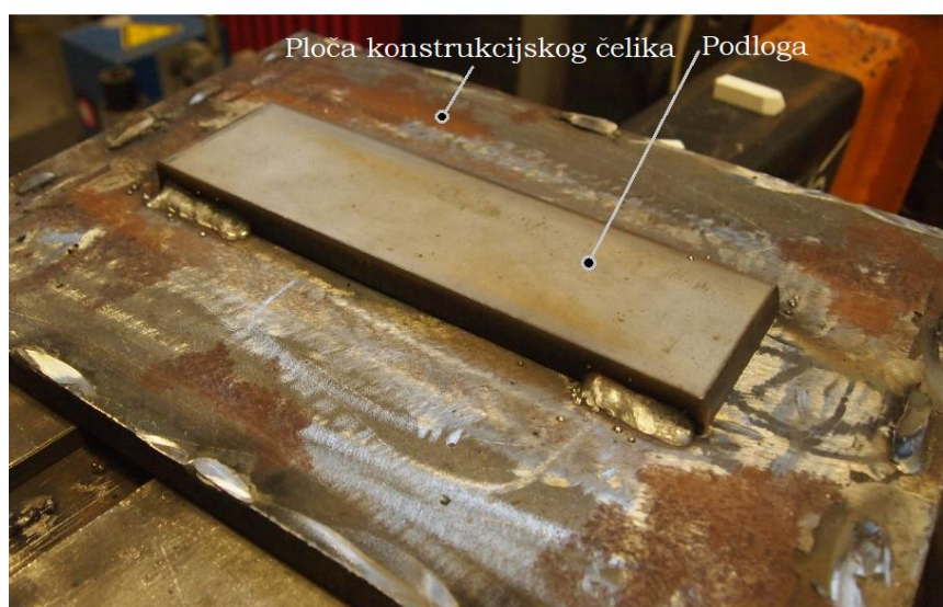
Slika 30. Pripojena podloga za ploču od konstrukcijskog čelika.
