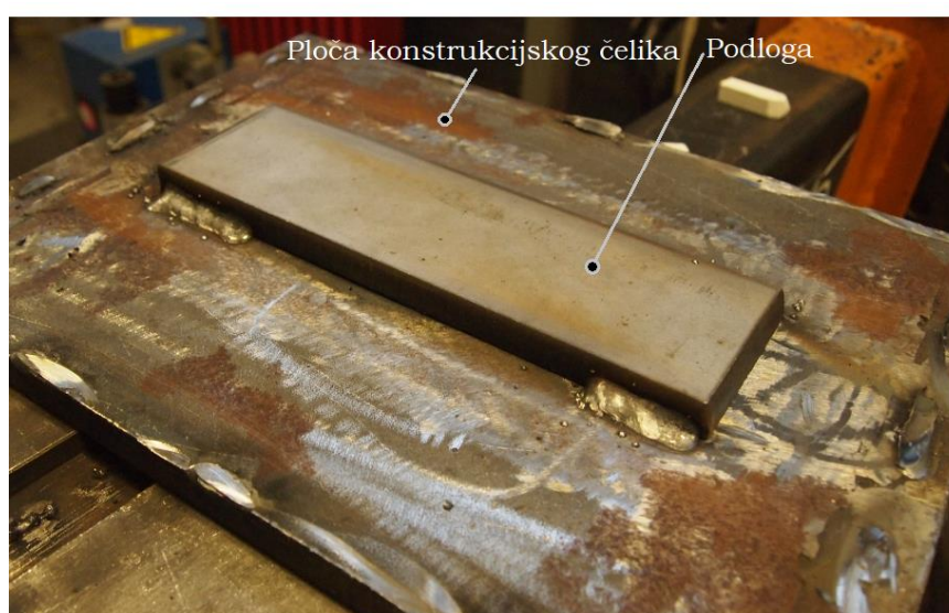
Slika 30. Pripojena podloga za ploču od konstrukcijskog čelika.
