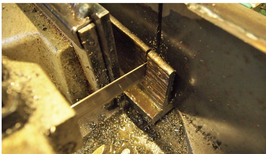
Slika 35. Rezanje tračnom pilom uzorka za makro i mikrostrukturnu analizu.
