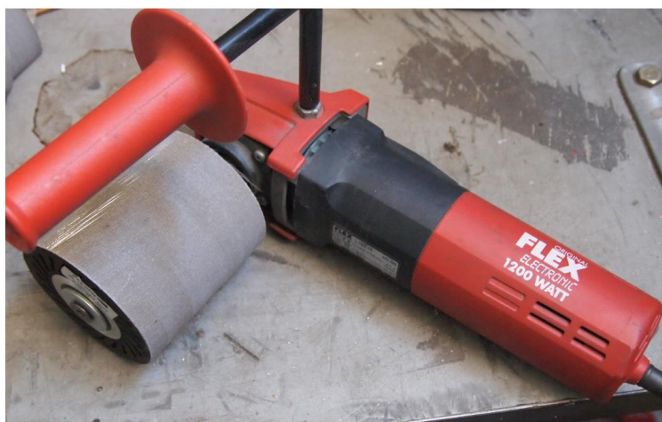
Slika 41. Prikaz električne brusilice s 3M Trizact brusnom trakom.
