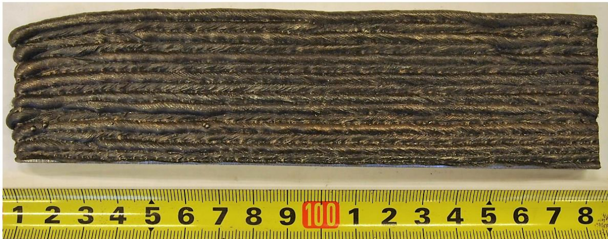
Slika 37. Uzorak zida nakon odvajanja od podloge i uklanjanja jednog kraja.
