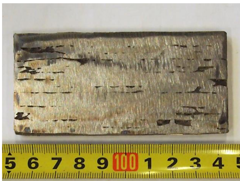
Slika 40. Uzorak zida obrađen ručnim brušenjem.
