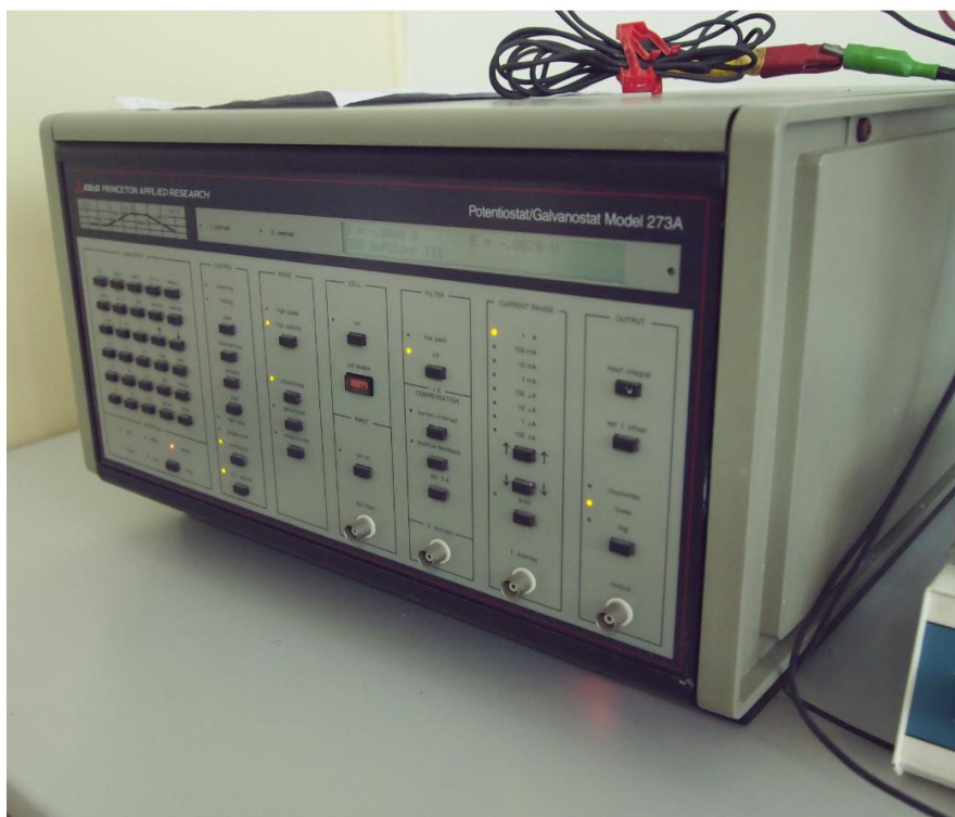
Slika 52. Potenciostat Model 273A korišten za elektrokemijska ispitivanja.
