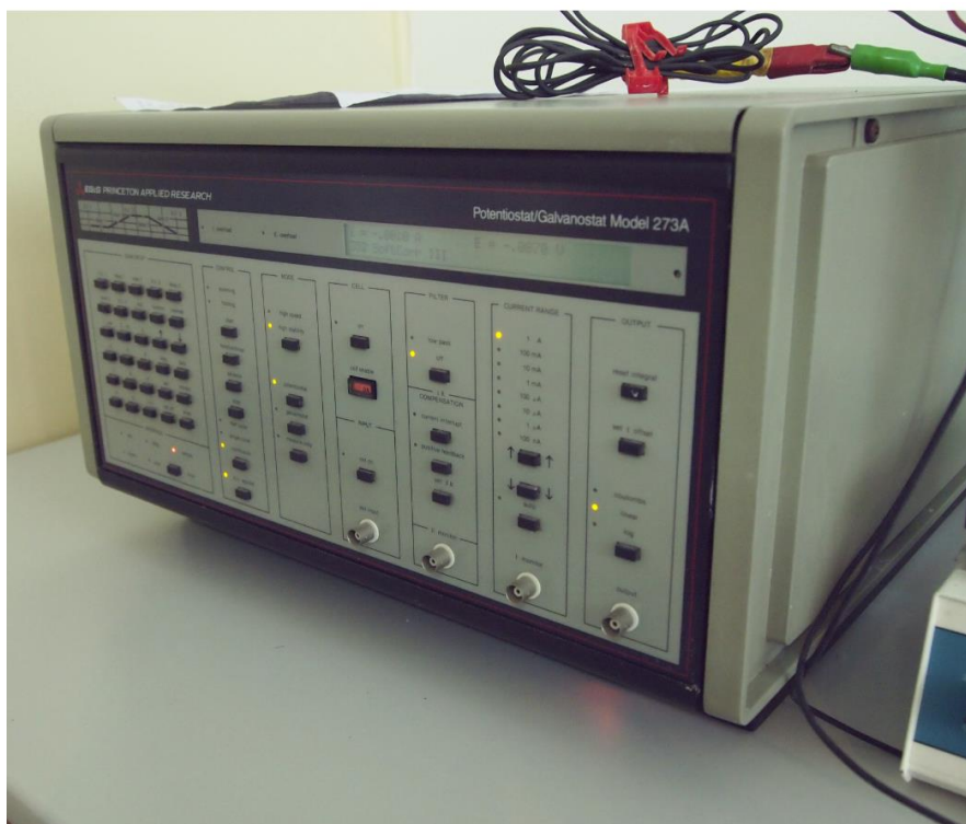
Slika 52. Potenciostat Model 273A korišten za elektrokemijska ispitivanja.
