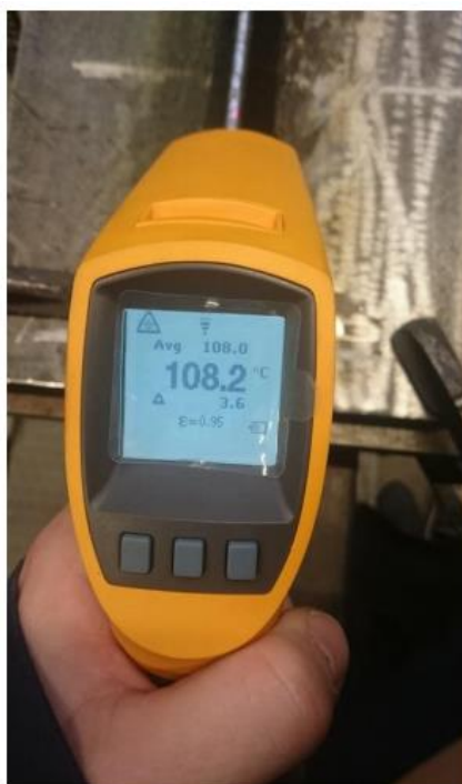
Slika 32. Mjerenje temperature prije izrade idućeg sloja – uređaj Temps Fluke 568 IR.
