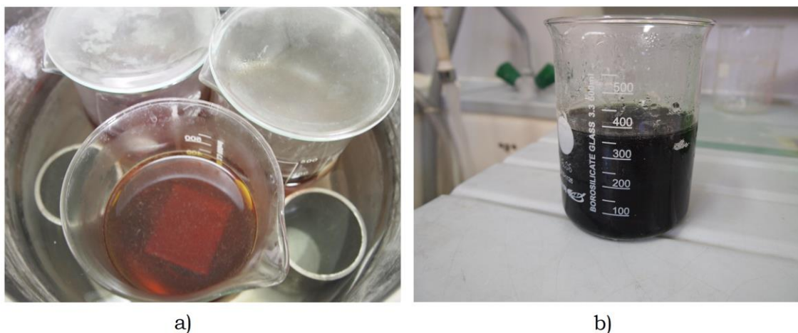
Slika 68. Prikaz provedbe korozivnog ispitivanja pri 50 \pm 2 °C: a) uzorak uronjen u otopinu \text{FeCl}_3 u vodenoj kupelji, b) vidljiva promjena boje otopine \text{FeCl}_3 nakon ispitivanja.
