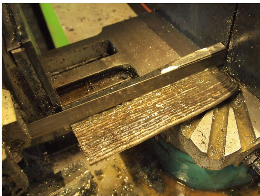
Slika 36. Rezanje podloge tračnom pilom.
