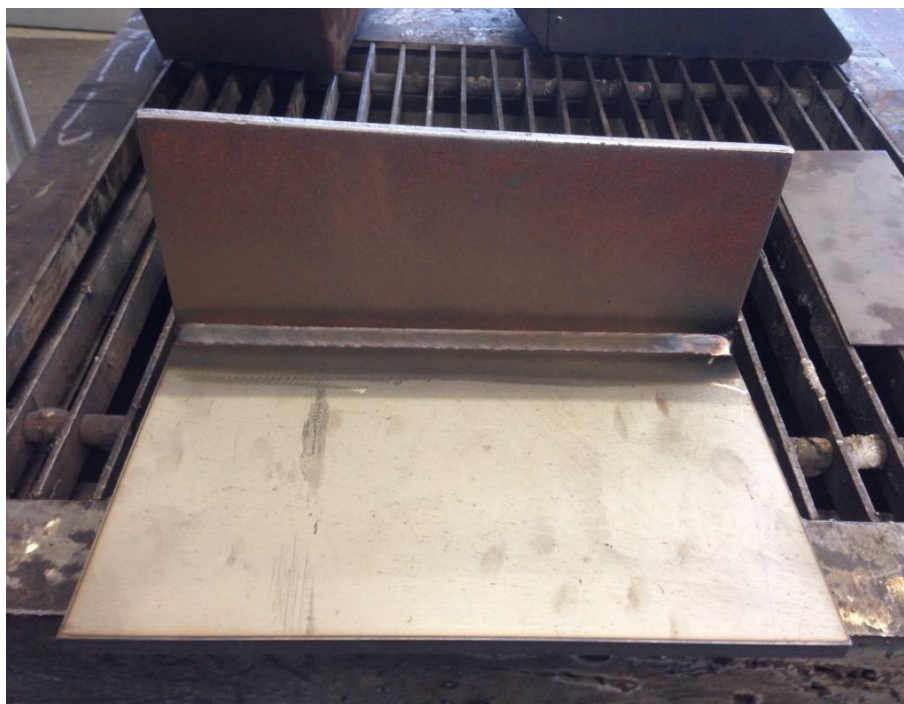
Slika 17. Uzorak 1 nakon zavarivanja
