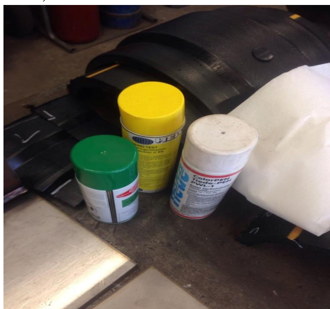
Slika 19. čistač, pentrant i razvijaj
