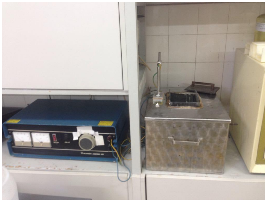
Slika 23. oprema za elektrolitičko ispitivanje
