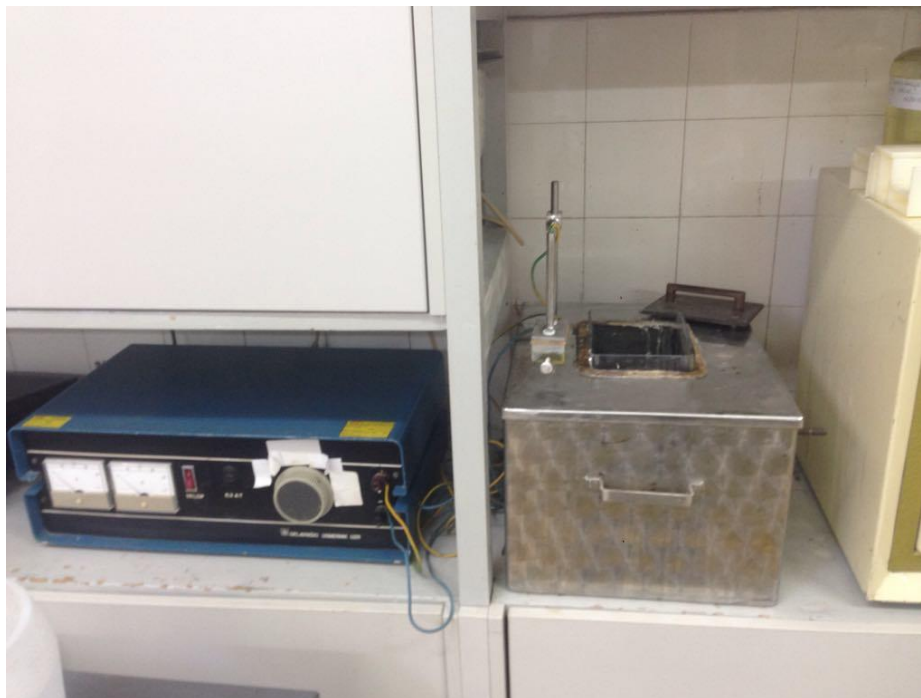
Slika 23. oprema za elektrolitičko ispitivanje
