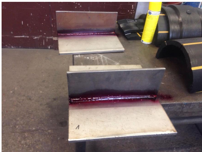
Slika 20. površine zavarenih spojeva s nanesenim penetrantom
