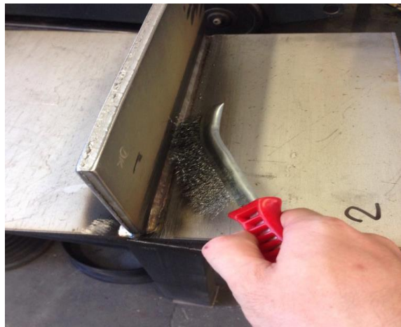
Slika 16. Čišćenje uzoraka četkom
