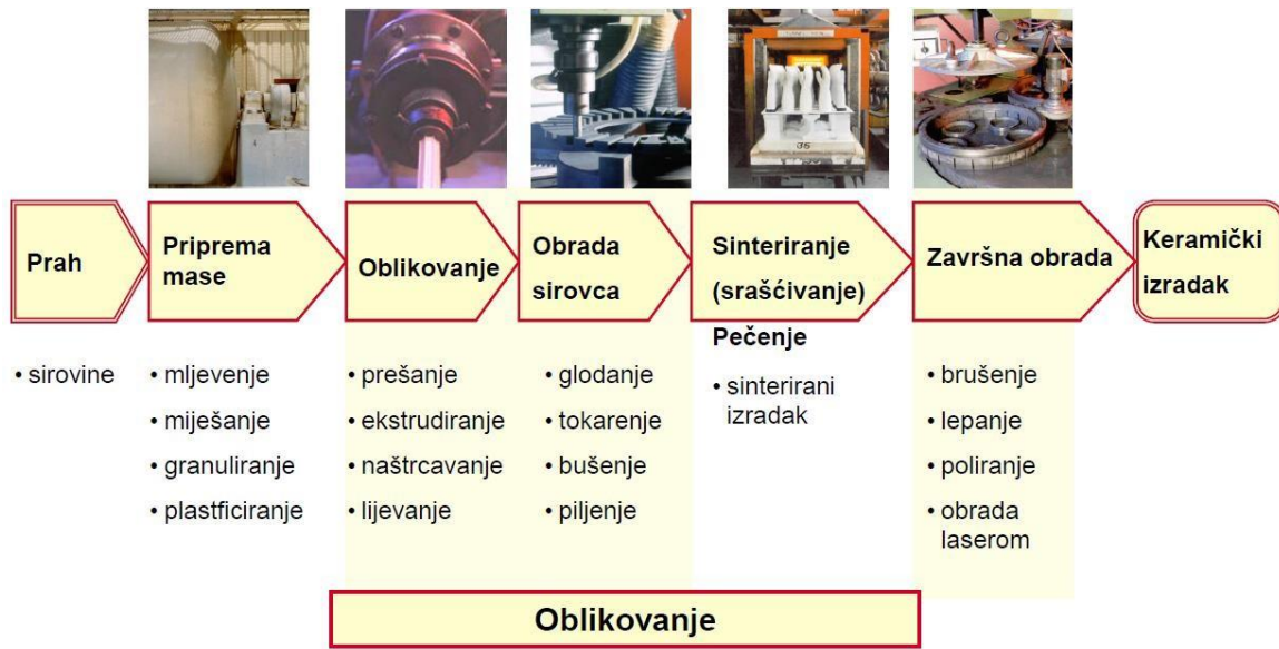
Slika 2.1 Dijagram tijeka proizvodnje tehničke keramike [7]
