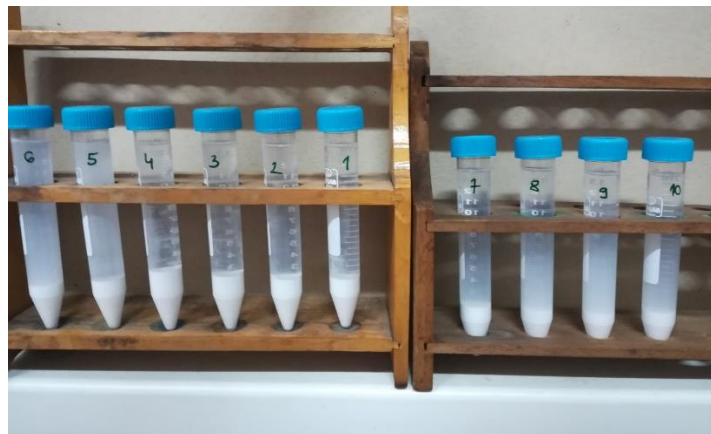
Slika 4.7. Fotografije epruveta s pripravljenim 20 %-tnim \text{Al}_2\text{O}_3 suspenzijama nakon 7 dana
