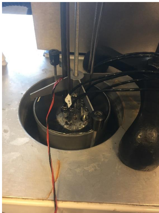
slika 8. Termometri uronjeni u izotermalni blok
