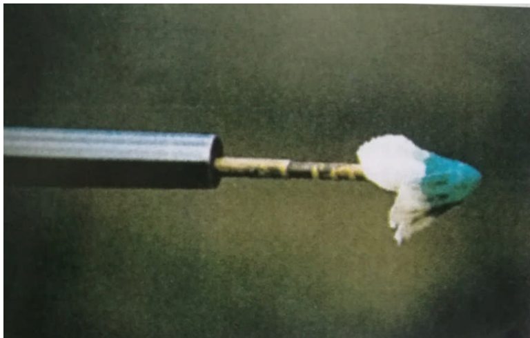
Slika 7.1. Obojena krpica pokazatelj prisustva nečistoća u cijevi [14]
