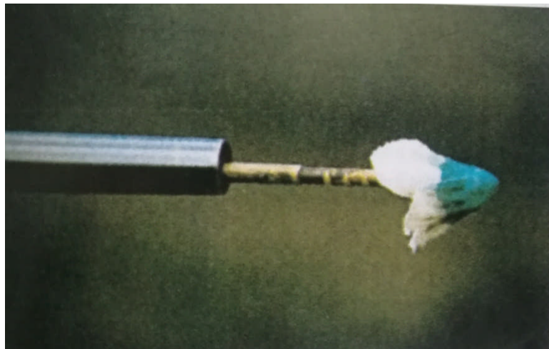
Slika 7.1. Obojena krpica pokazatelj prisustva nečistoća u cijevi [14]
