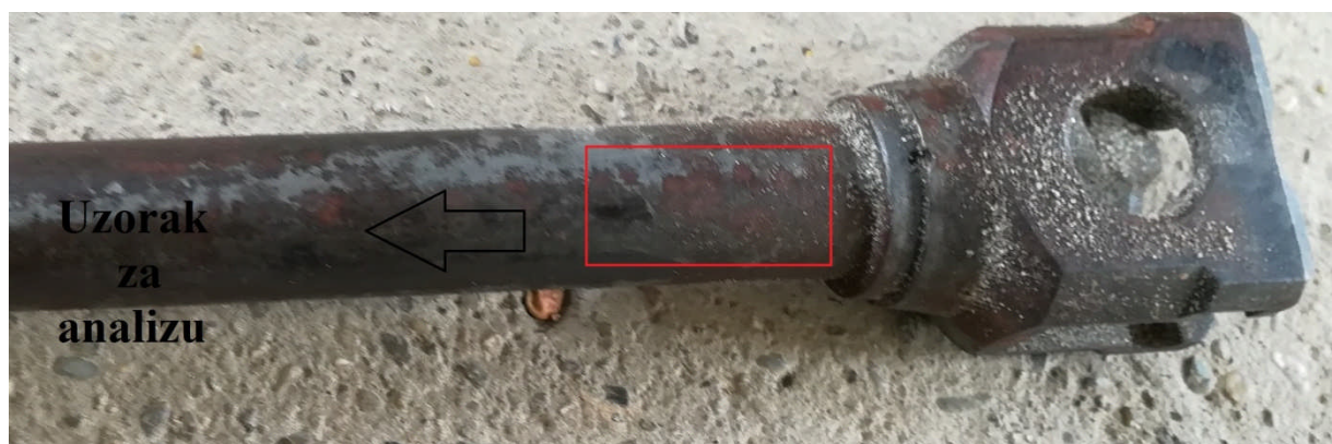
Slika 8.4. Uzimanje uzoraka cijevi lovačkog oružja
