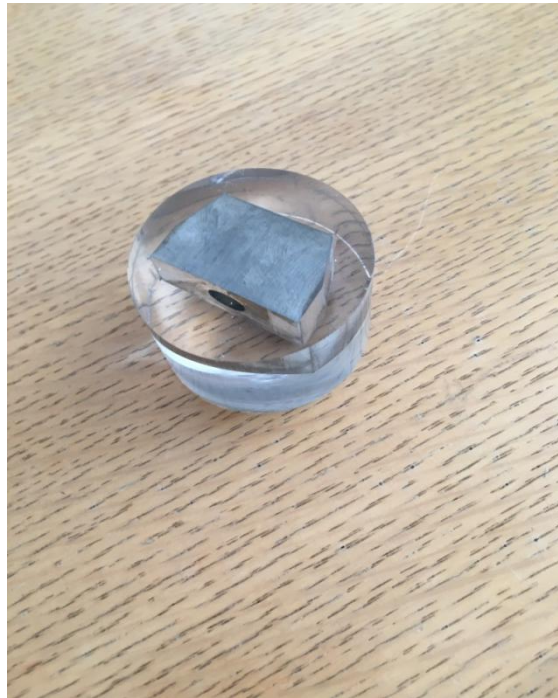
Slika 22. Uzorak zaliven u polimernoj masi
