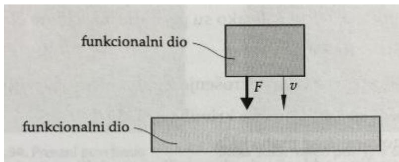
**Slika 18. Shema tribosustava pri udarnom trošenju [8]**
