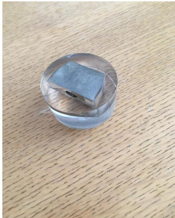
**Slika 22. Uzorak zaliven u polimernoj masi**
