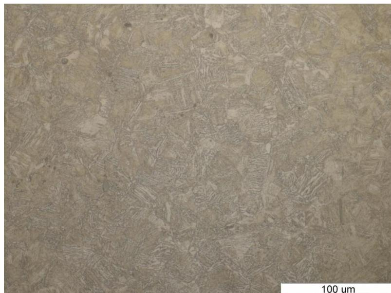
**Slika 27. Mikrostruktura jezgre pod povećanjem od 500x**
