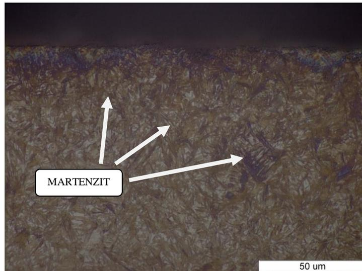
**Slika 26. Mikrostruktura ruba pod povećanjem od 1000x**
