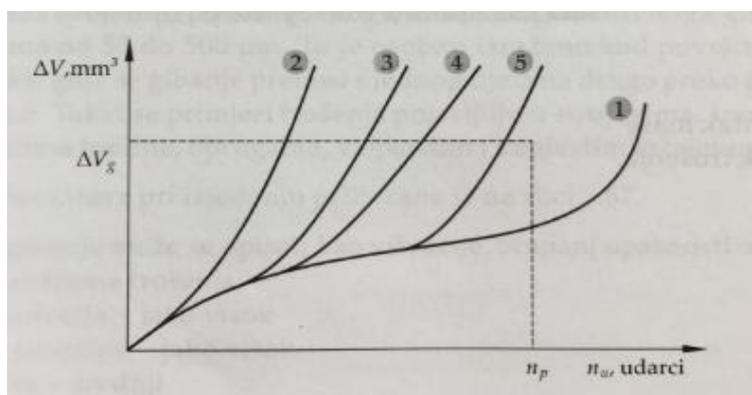
**Slika 19. Procesi trošenja tribosustava s udarnim opterećenjem [8]**
