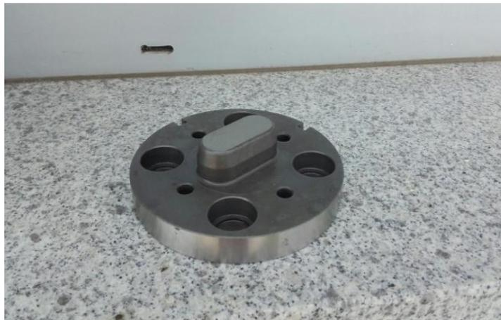
Slika 7. Alat za izvlačenje elipsi [2]
