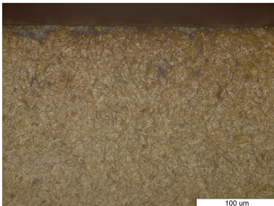
Slika 25. Mikrostruktura ruba pod povećanjem od 500x
