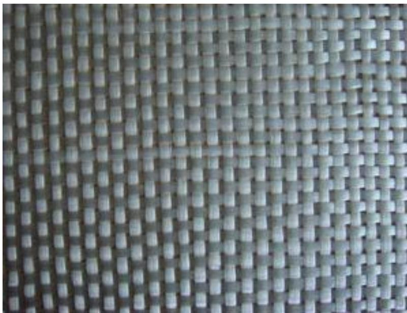
Slika 3.2. Roving staklena vlakna
