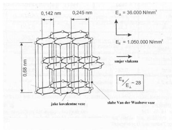
Slika 2.7. Idealna struktura jednog ugljikovog vlakna (7)
