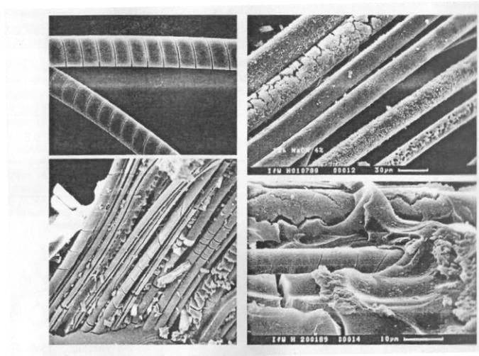
Slika 2.4. Razgradnja E-staklenih vlakna, REM snimka (7)
