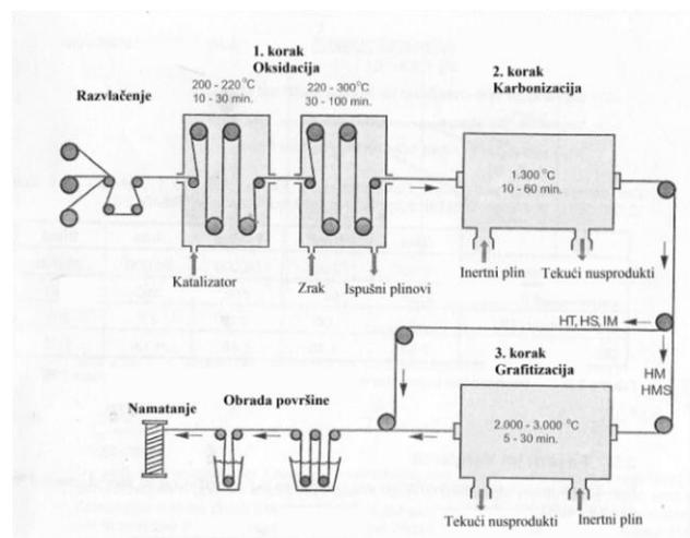
Slika 2.9. Proizvodnja ugljičnih vlakana iz PAN-a (7)
