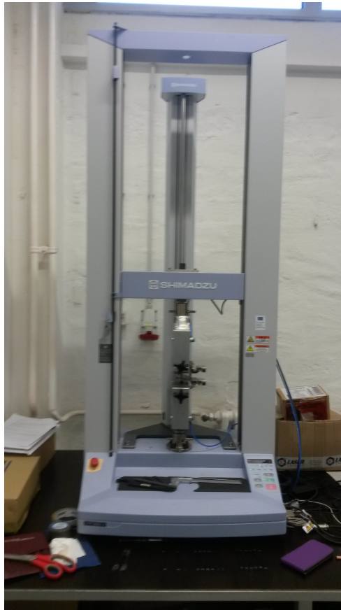
Slika 4.1: Kidalica na kojoj je obavljen eksperiment
