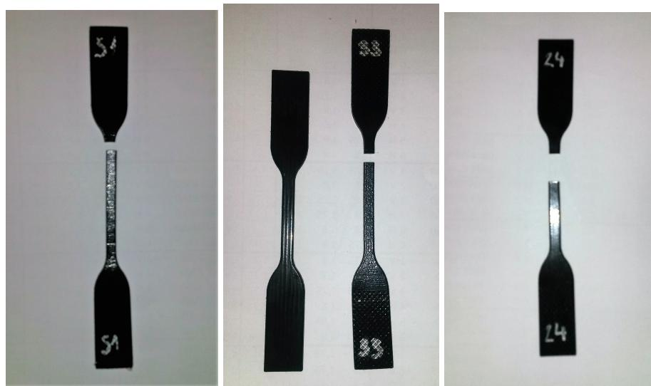
Slika 4.4: Testirane epruvete
