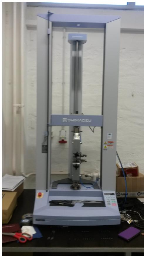
Slika 4.1: Kidalica na kojoj je obavljen eksperiment
