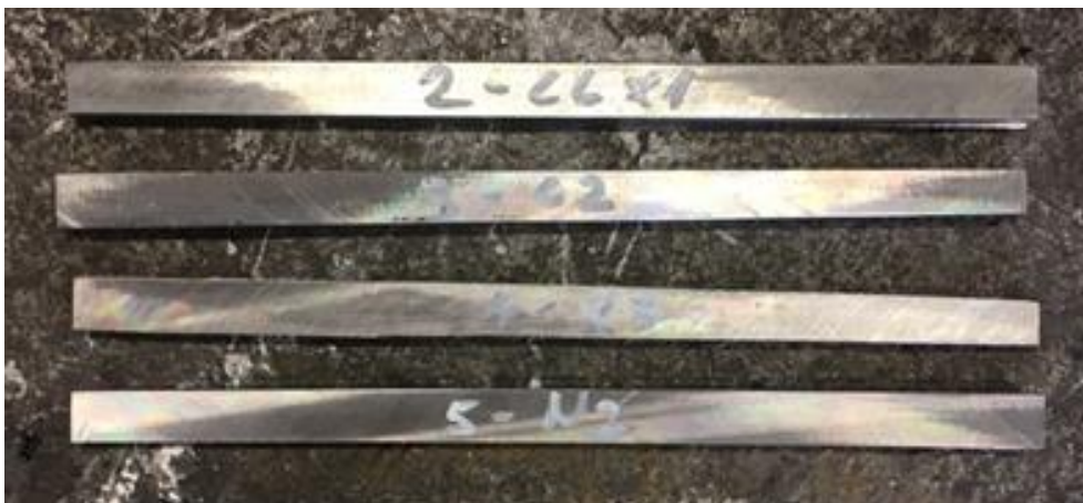
Slika 30. Epruvete izrezane iz zida izrađenog WAAM postupkom
