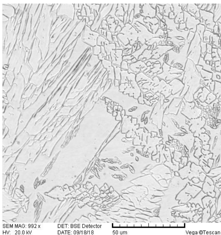
Slika 54. Mikrostruktura uzorka 4 promatrana SEM mikroskopom
