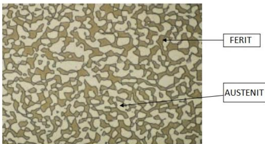
Slika 9. Mikrostruktura dupleks čelika [21]
