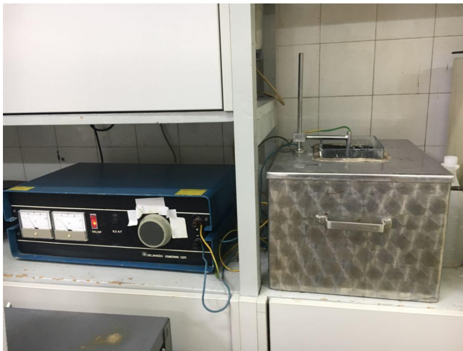
Slika 39. Uređaj za nagrivanje
