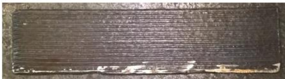
Slika 25. Odrezani zid s podloge za navarivanje [30]
