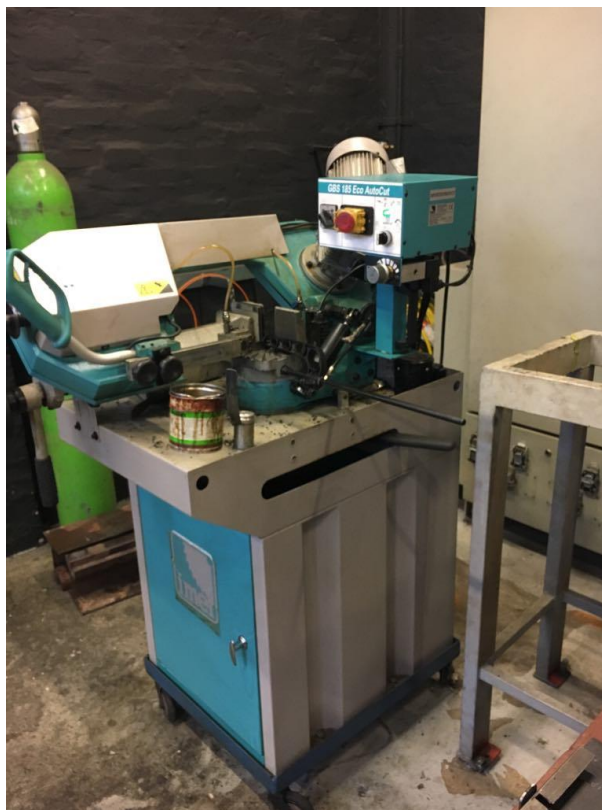
Slika 32. Tračna pila GBS 185 Eco AutoCut
