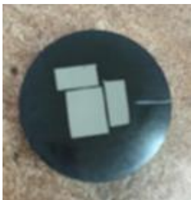
Slika 38. Izgled uzorka prije nagrivanja površine
