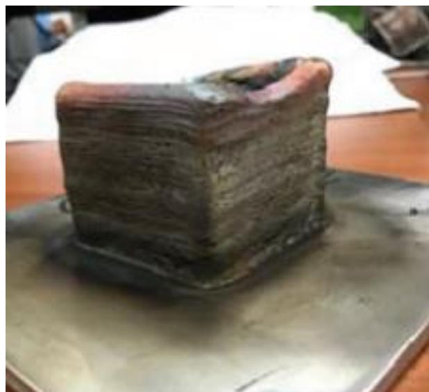
**Slika 6. Komponenta od austenitnog nehrdajućeg čelika izrađena WAAM postupkom [15]**
