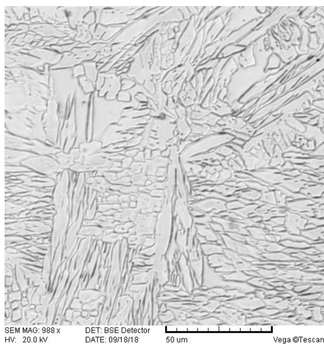
Slika 53. Mikrostruktura uzorka 3 promatrana SEM mikroskopom
