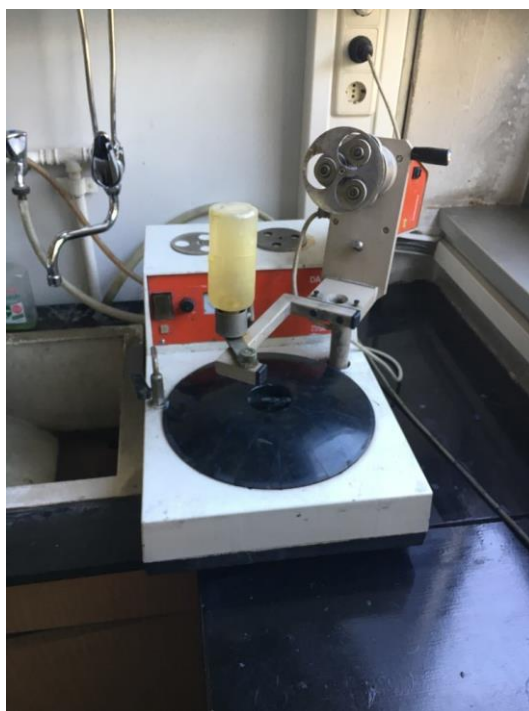
Slika 37. Uređaj za poliranje uzoraka
