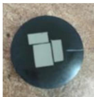
**Slika 38. Izgled uzorka prije nagrizanja površine**
