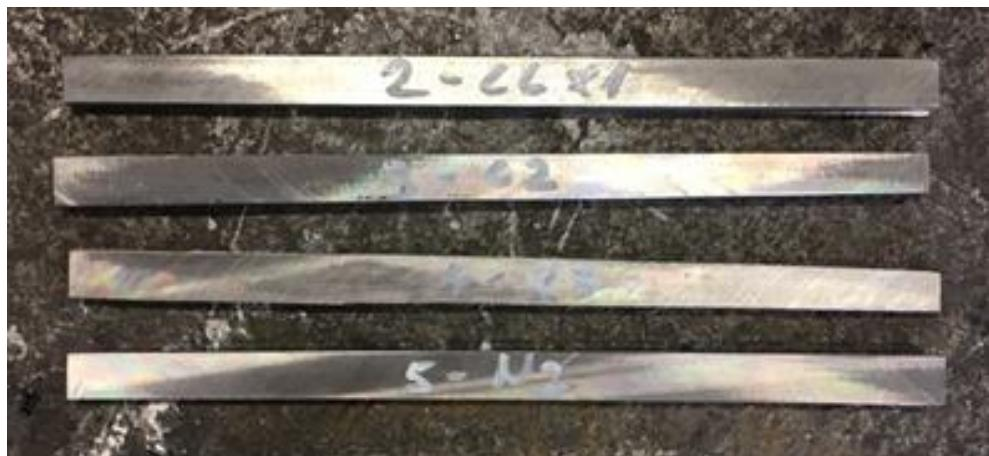
Slika 30. Epruvete izrezane iz zida izrađenog WAAM postupkom
