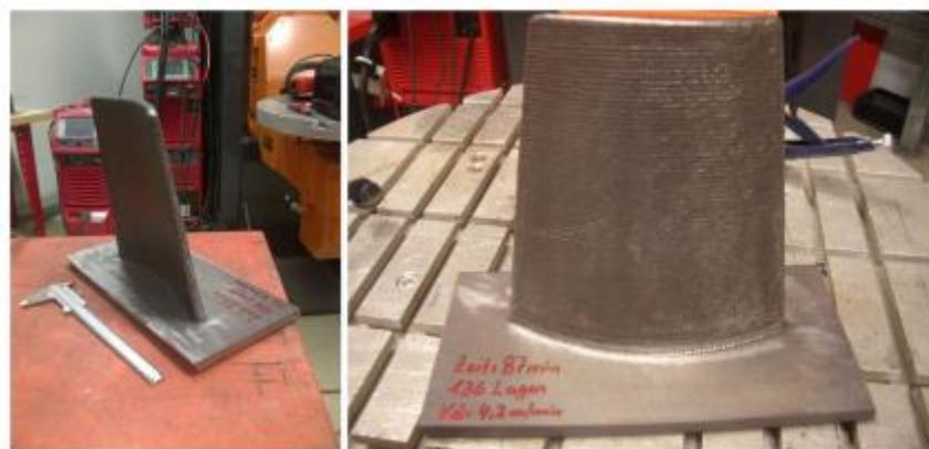
**Slika 5. Komponenta izrađena od dupleks nehrđajućeg čelika WAAM postupkom [14]**
