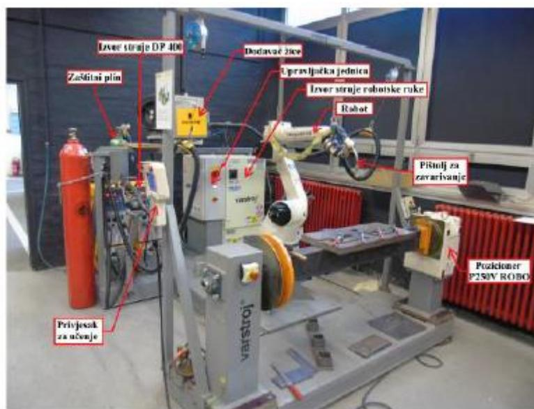
Slika 23. Robotska stanica Almega OTC AX V6 [6]
