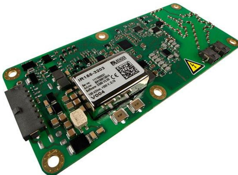
Slika 11. Uređaj za nadzor izolacije [10]
