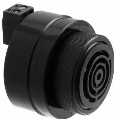
Slika 41. Piezo zvučnik upotrijebljen za zvučnu signalizaciju [29]
