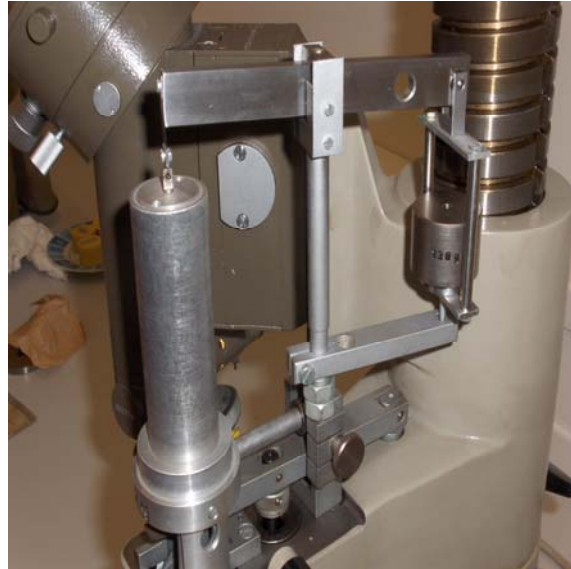
Slika 24: Polužni sustav za mjerenje mikrotvrdoće
