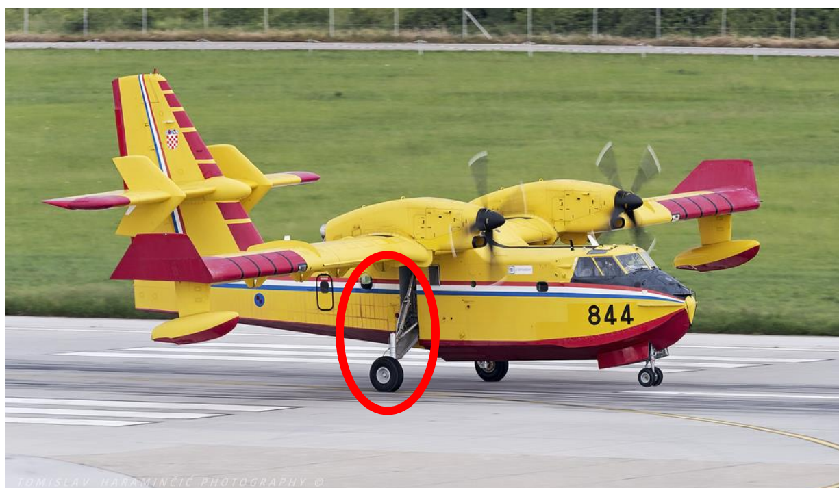
Slika 2. Glavna noga stajnog trapa prilikom rulanja [3]
