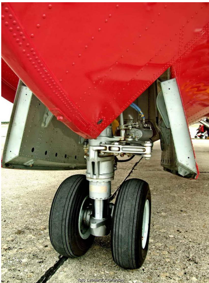
Slika 3. Nosna noga s duplim kotačem [6]
