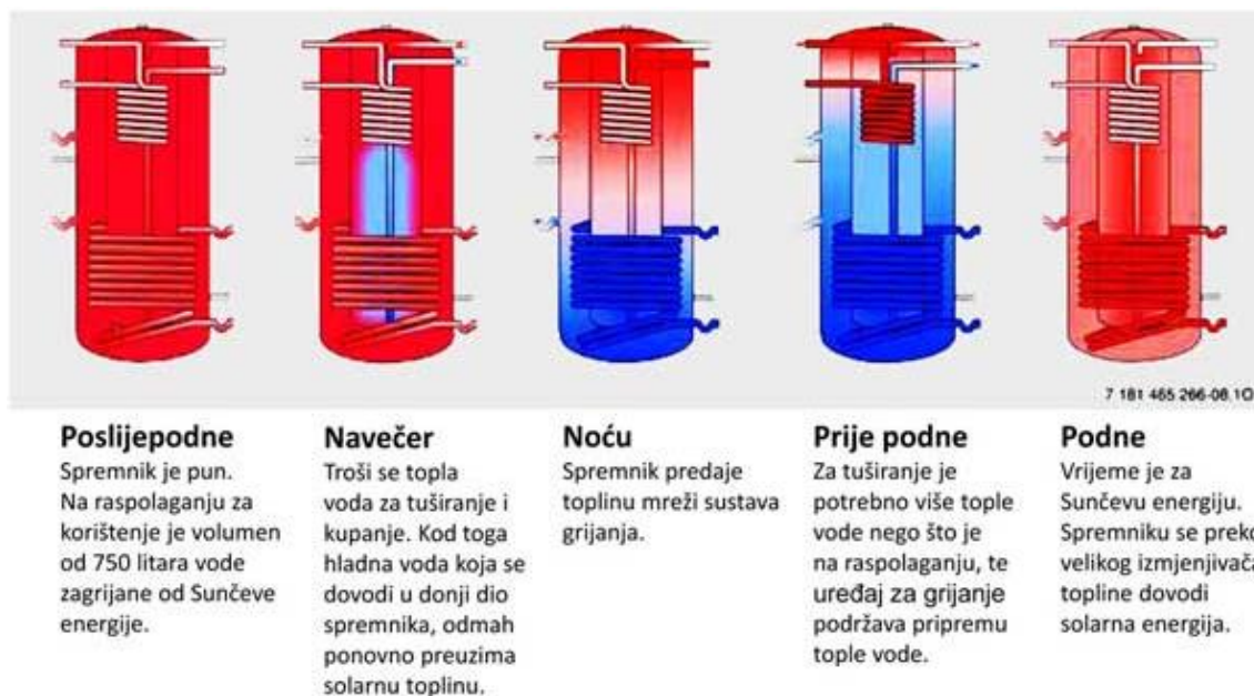
Slika 7 Princip rada Bosch solarnog kombiniranog spremnika za PTV i podrška grijanju [11]
