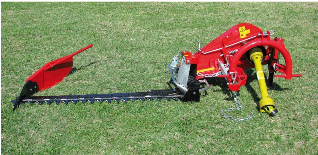
Slika 5 Oscilirajuća ksilica za travu [5]
