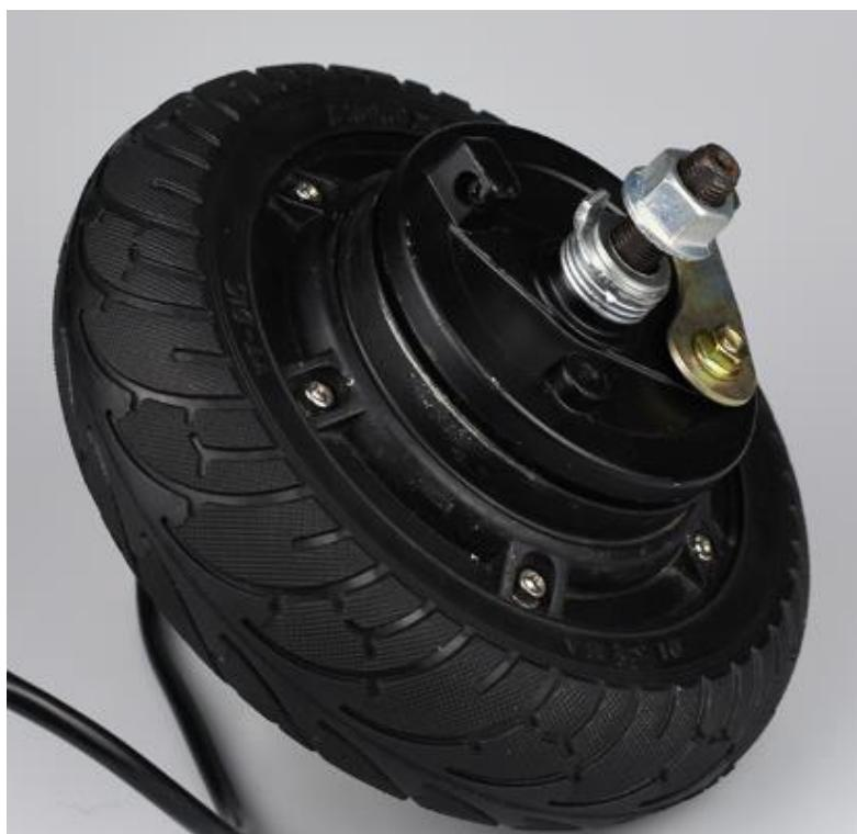
**Slika 18. Pogonski sklop Kun Ray 48V 350W [18]**
