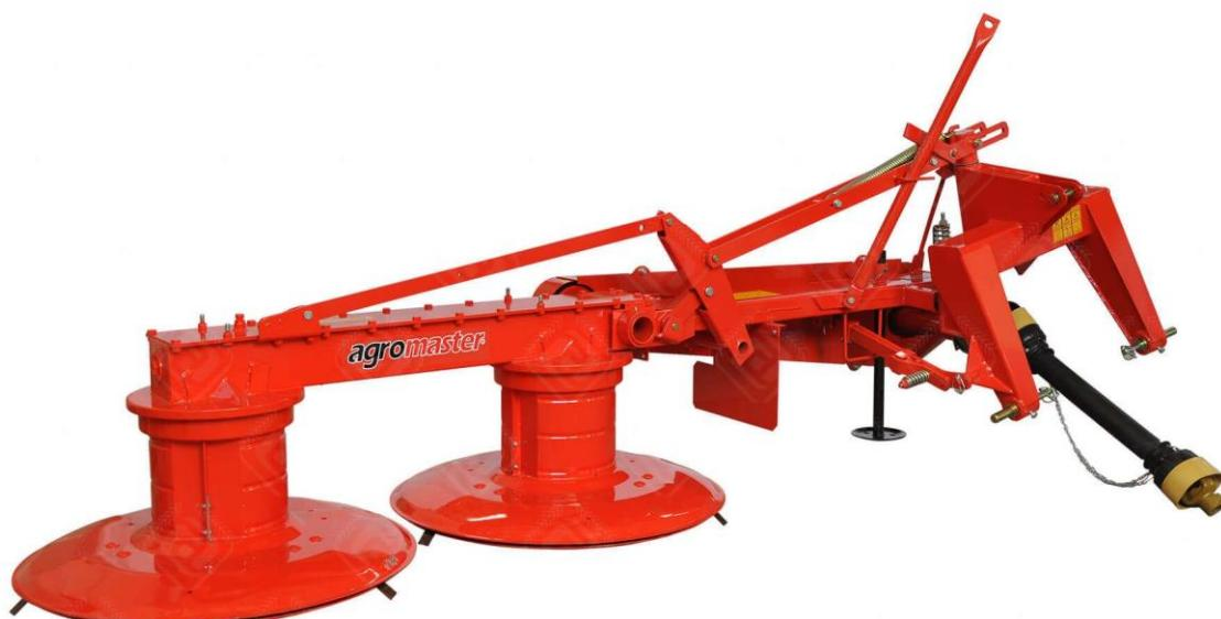
**Slika 7 Bubanjska kosilica za travu [7]**
