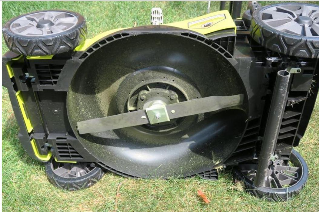
**Slika 6 Rotacijska kosilica za travu [6]**
