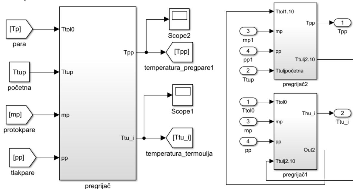
Slika 4.6.9 Shema pregrijača izvana (lijevo) i iznutra (desno)
