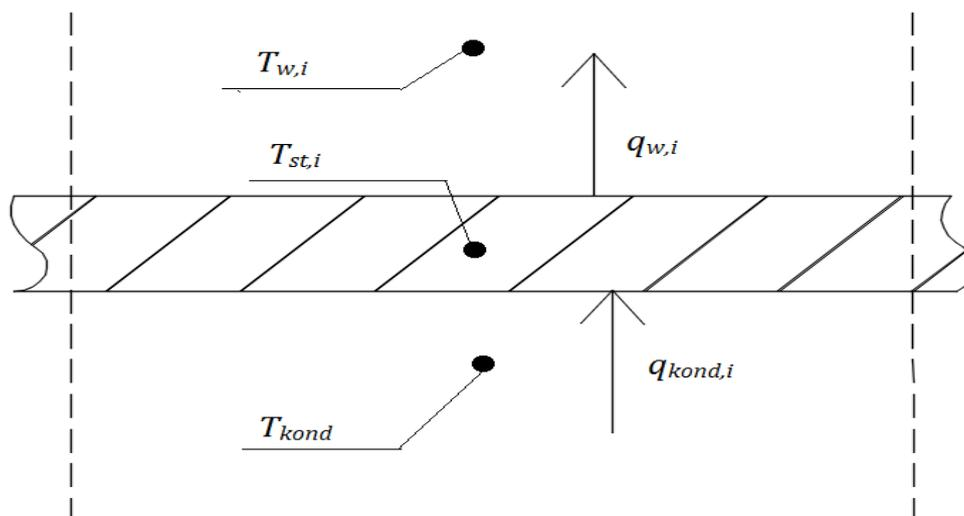
Slika 4.6.3 Prikaz akumulacije topline u stijenci cijevi kondenzatora
