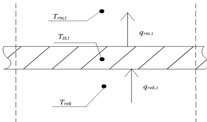
Slika 4.5.3 Prikaz akumulacije topline u stijenci cijevi rekuperatora
