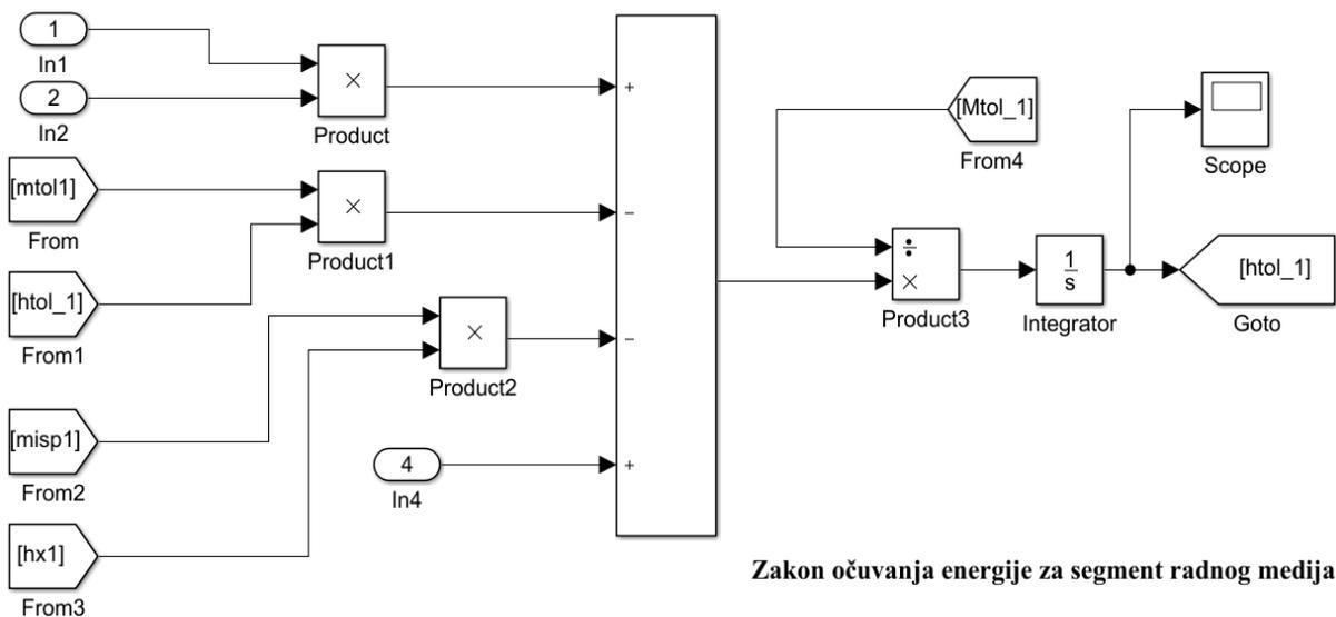
Slika 4.6.6 Shema kontrolnog volumena radnog medija u isparivaču
