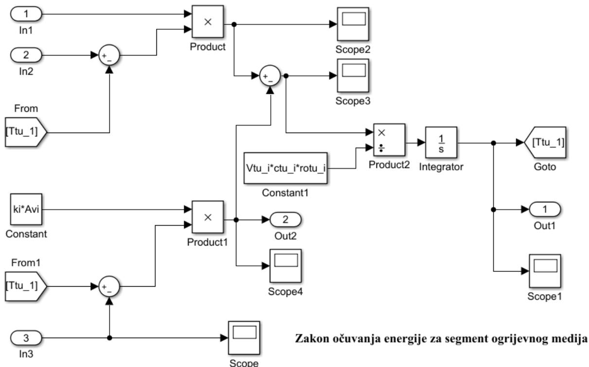
Slika 4.6.5 Shema kontrolnog volumena ogrjevnog medija u isparivaču
