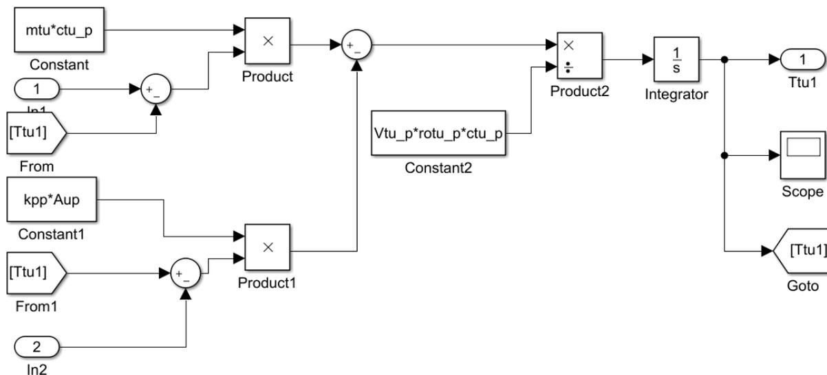
Slika 4.6.12 Shema kontrolnih volumena ogrjevnog medija unutar pregrijača
