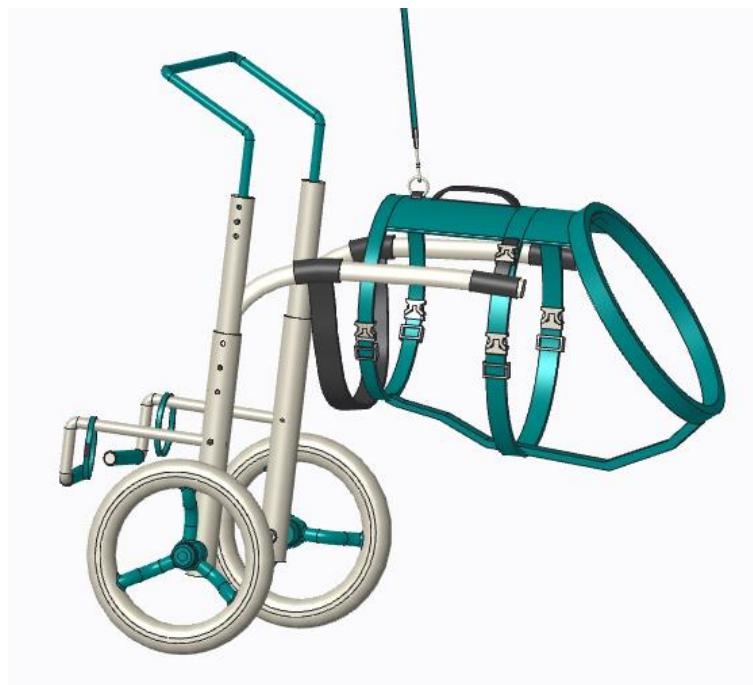
Slika 49: 3D model konstrukcijskog rješenja bez psa
