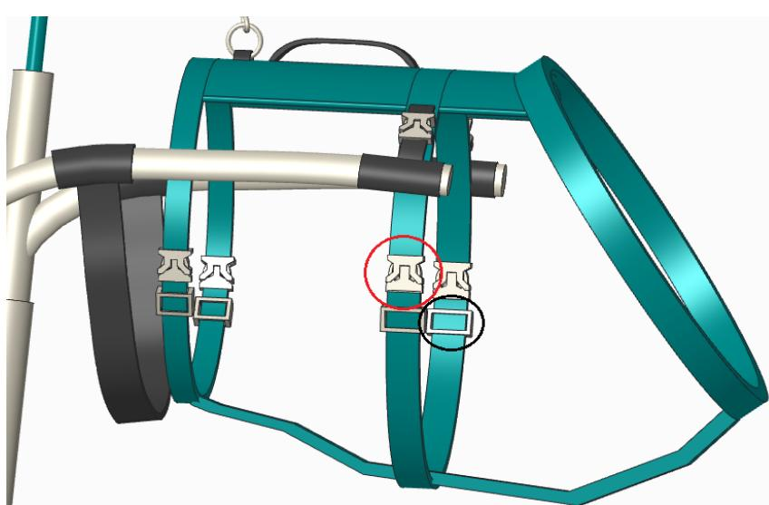
Slika 50: Kopča na konstrukciji i sistem za podešavanje dimenzija
