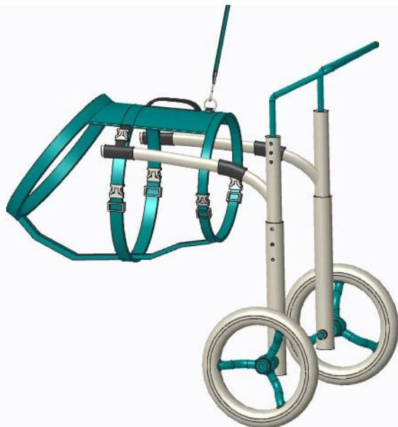
**Slika 57: Konstrukcijsko rješenje za pse s nogama s postojećom lokomotornom funkcijom**
