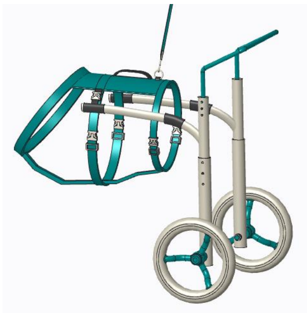
Slika 57: Konstruktivno rješenje za pse s nogama s postojećom lokomotornom funkcijom
