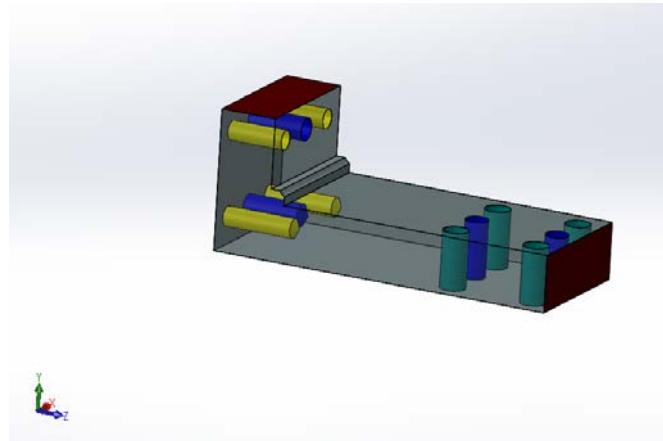
**Slika 21. Primjer prolaznih i slijepih provrta na elementu**
