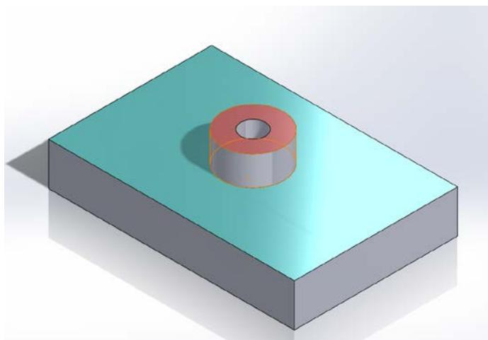
**Slika 31. Primjer unutarnjih petlji na ravnoj površini**
