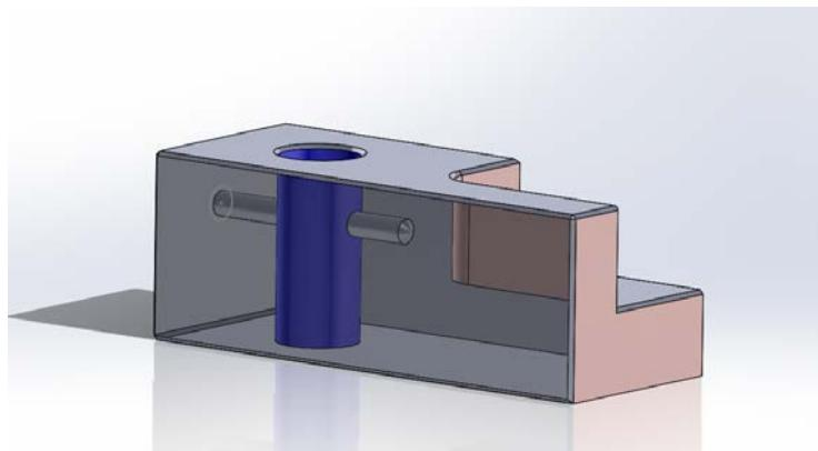
**Slika 34. Bušenje provrta kroz stjenku provrta**
