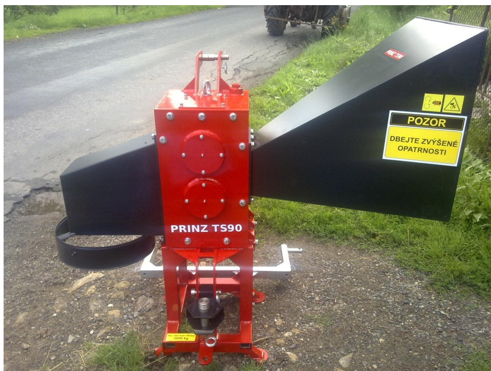
Slika 6. Uređaj za usitnjavanje drvnih ostataka Prinz TS90 [6]
