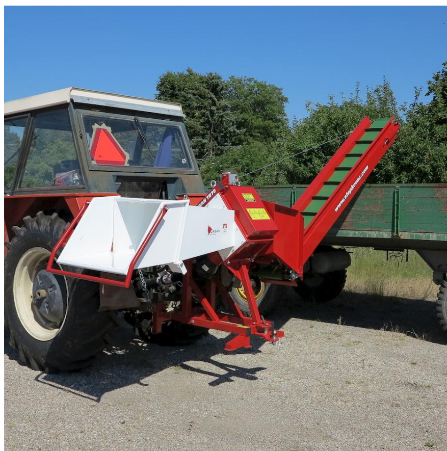
Slika 5. Uređaj za usitnjavanje drvnih ostataka Urban TR 70 [5]
