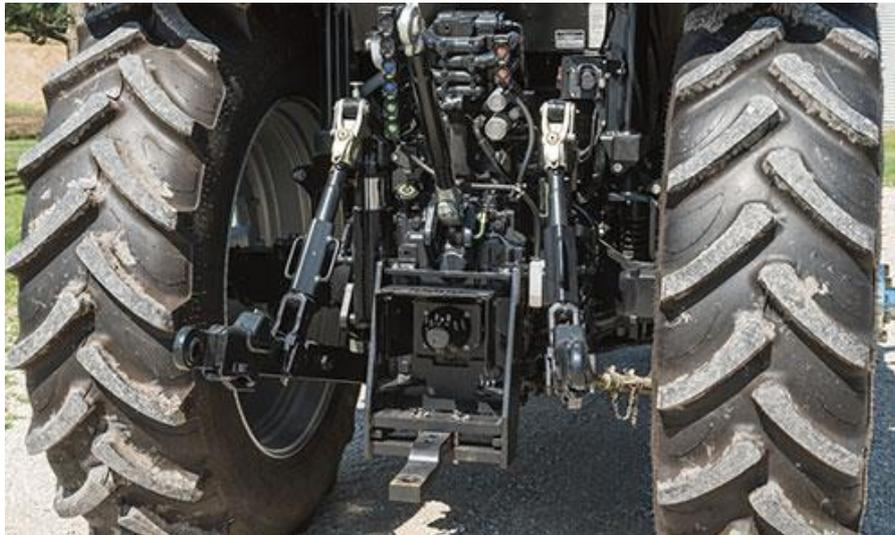
Slika 7. Traktorski priključak u tri točke [7]
