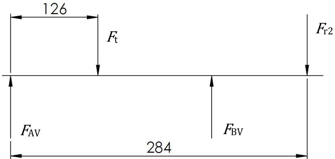
Slika 17. Opterećenje vratila u vertikalnoj ravnini
