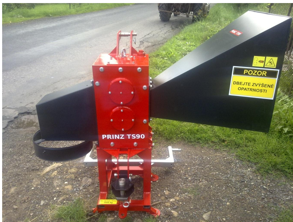
Slika 6. Uređaj za usitnjavanje drvnih ostataka Prinz TS90 [6]
