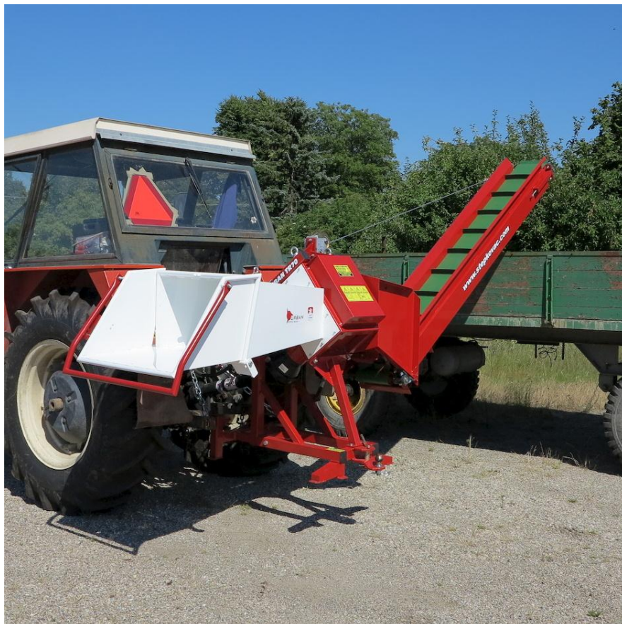
Slika 5. Uređaj za usitnjavanje drvnih ostataka Urban TR 70 [5]
