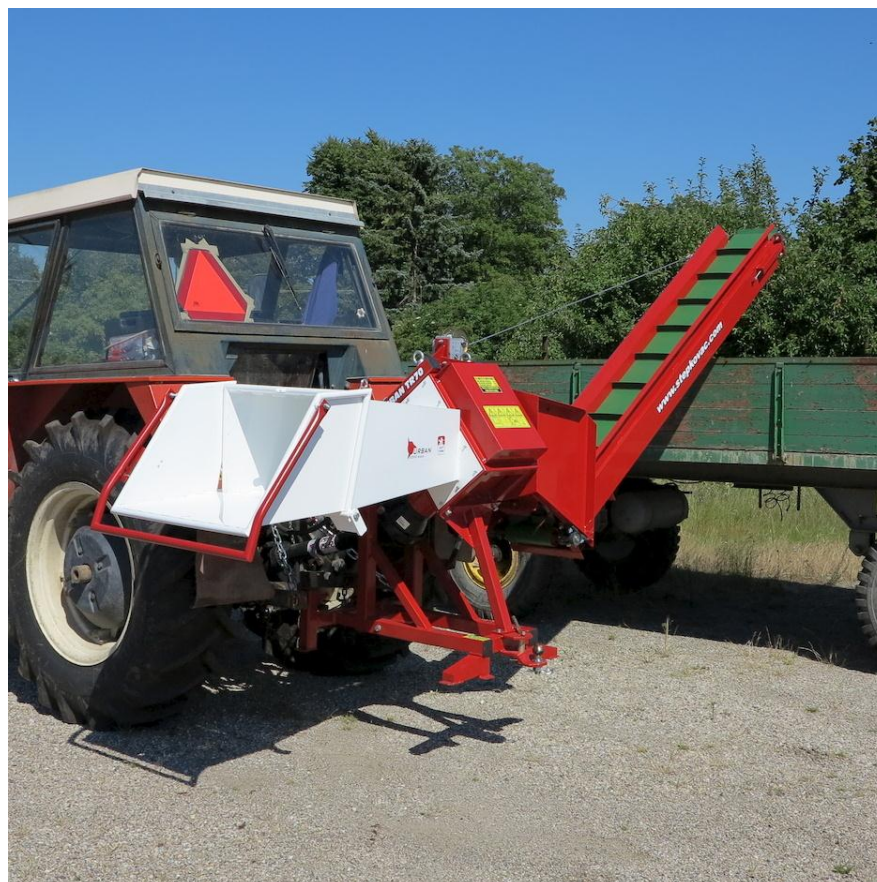
Slika 5. Uređaj za usitnjavanje drvnih ostataka Urban TR 70 [5]
