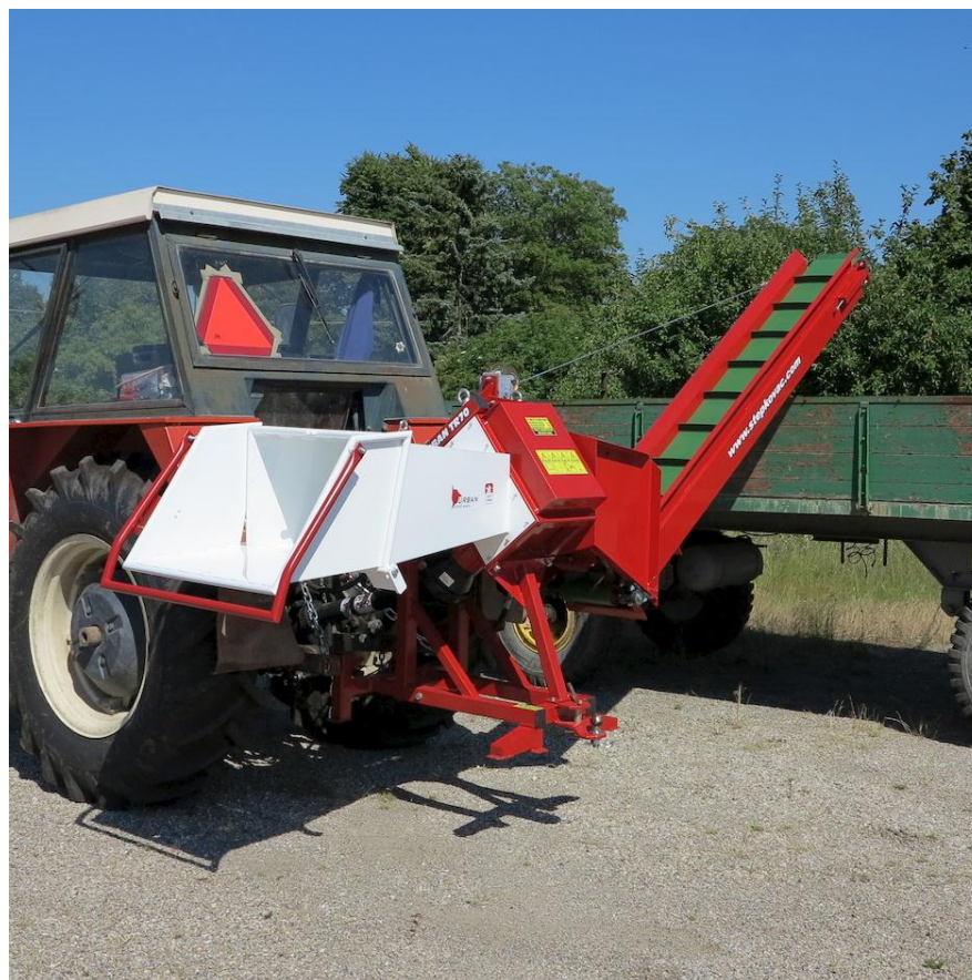
Slika 5. Uređaj za usitnjavanje drvnih ostataka Urban TR 70 [5]
