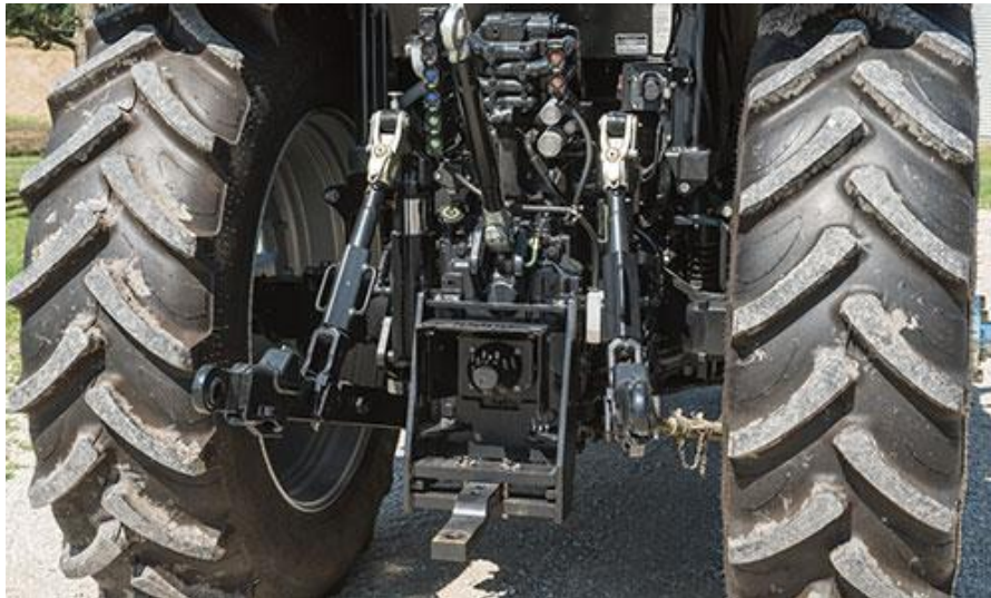
Slika 7. Traktorski priključak u tri točke [7]
