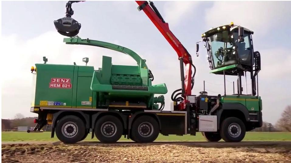
Slika 2. Uređaj za usitnjavanje drvnih ostataka velikih dimenzija [2]
