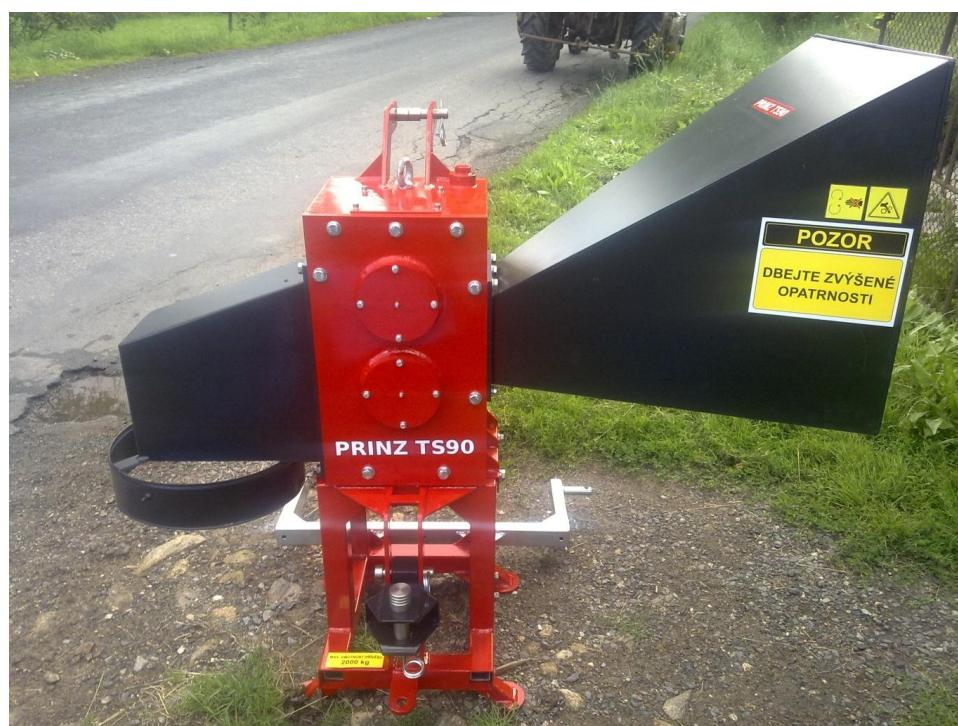
Slika 6. Uređaj za usitnjavanje drvnih ostataka Prinz TS90 [6]
