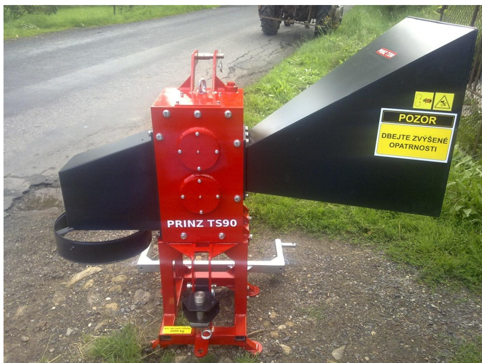
Slika 6. Uređaj za usitnjavanje drvnih ostataka Prinz TS90 [6]
