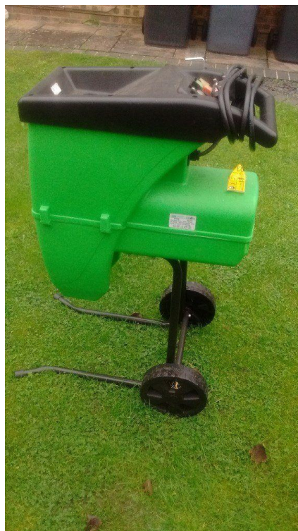
Slika 1. Električni uređaj za usitnjavanje snage 2 kW [1]
