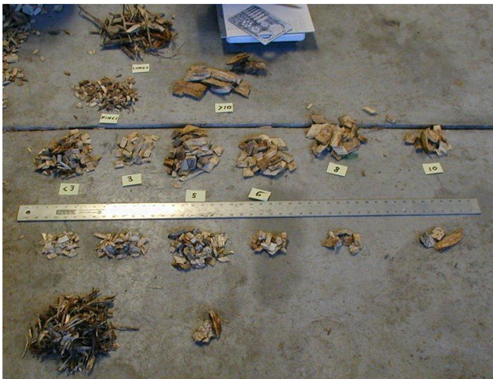
Slika 3. Usitnjeni drvni ostatci razne veličine [3]
