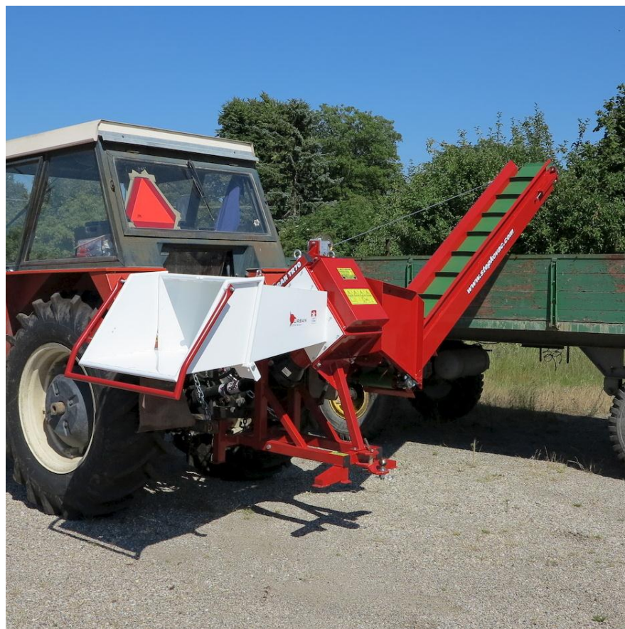
Slika 5. Uređaj za usitnjavanje drvnih ostataka Urban TR 70 [5]
