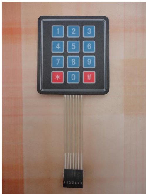
Slika 7. Matrična tipkovnica 4x3
