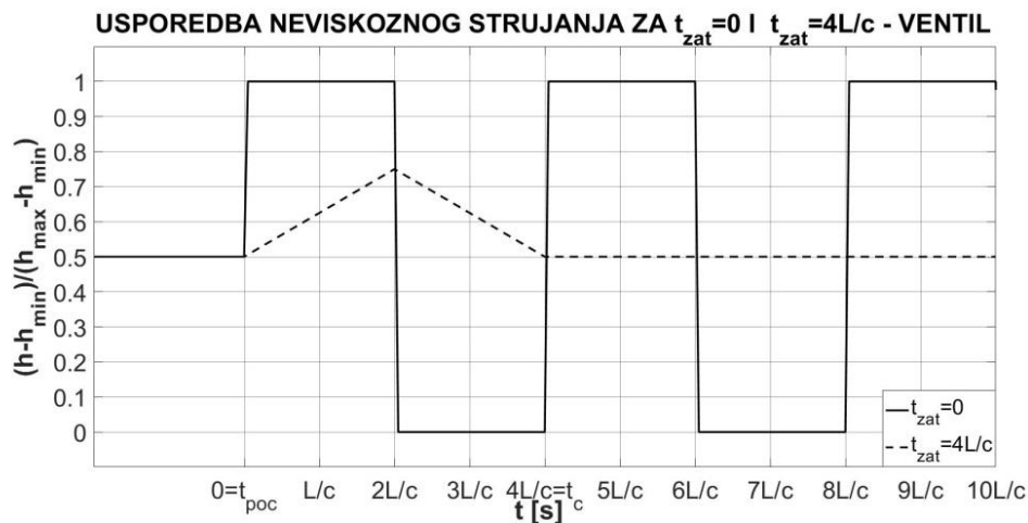
Slika 60 – Usporedba promjene piezometričke visine na mjestu ventila za vrijeme zatvaranja ventila t_{zat} = 0 i t_{zat} = 4L/c pri neviskoznom strujanju fluida
